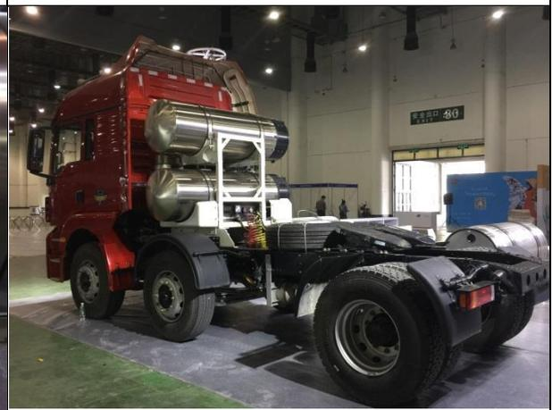
圖12 LNG產業先進技術和產品進行展覽展示6：西安德森新能源裝備公司車用LNG儲罐
