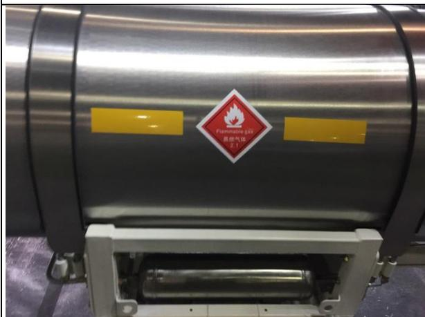
圖11 LNG產業先進技術和產品進行展覽展示5：西安德森新能源裝備公司車用LNG儲罐
