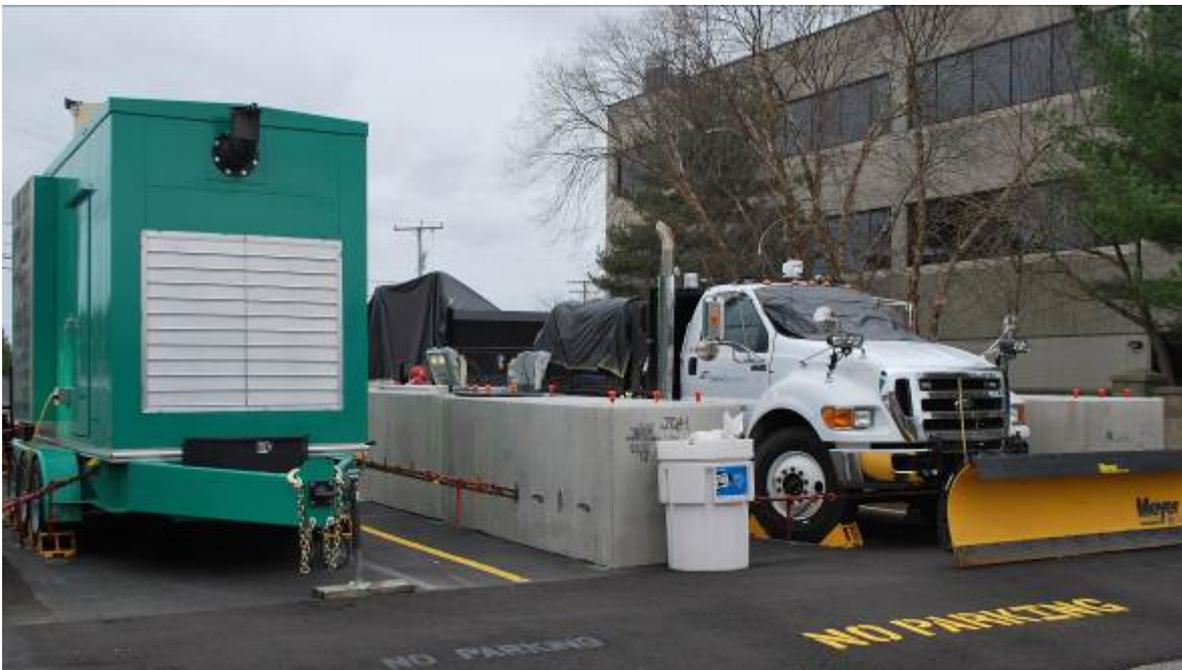
說明：OC 電廠 FLEX 設備-移動式 PUMP 及水帶車
