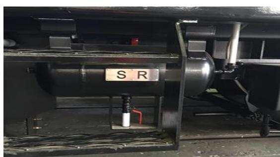
位於調動機右側的 MR(60L) ，後面有 AC 輔助風缸(25L) ，是透過分配閥來補充
