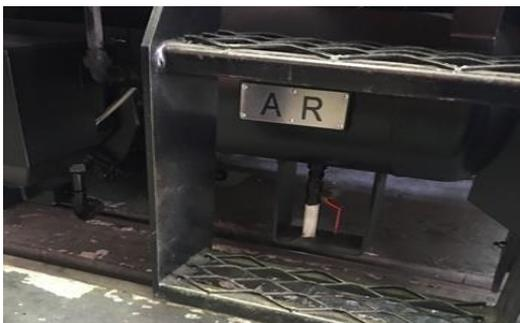
位於調動機左側前方的停留軔機輔助風缸(25L)
