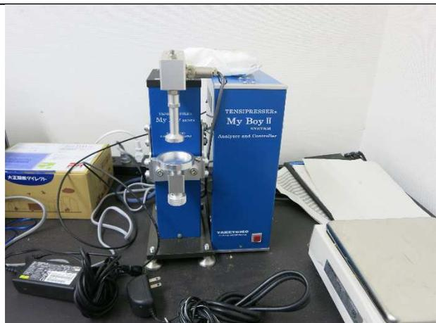
圖 35、米飯物理特性測定儀器。
