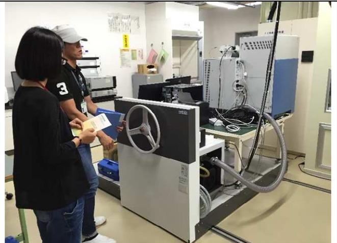
圖 10、可隨軌道移動的質譜儀系統。
