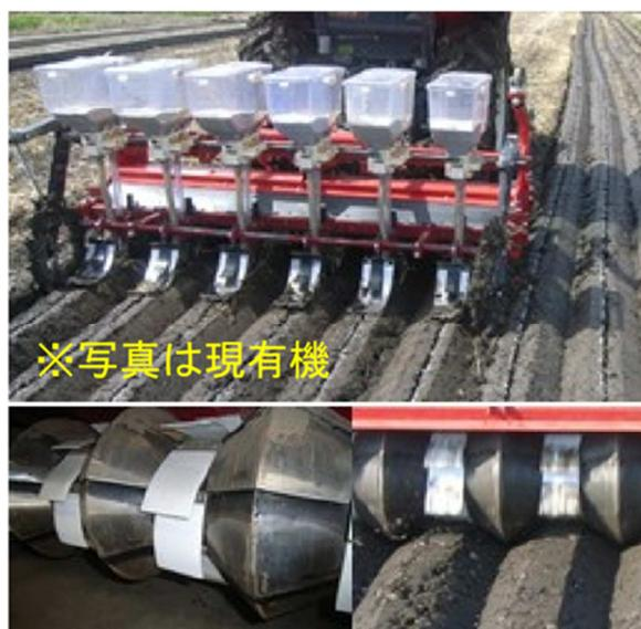
※播種畝を台形状かつ表面を硬く成形して、初期雑草の抑制と漏水を防止。
