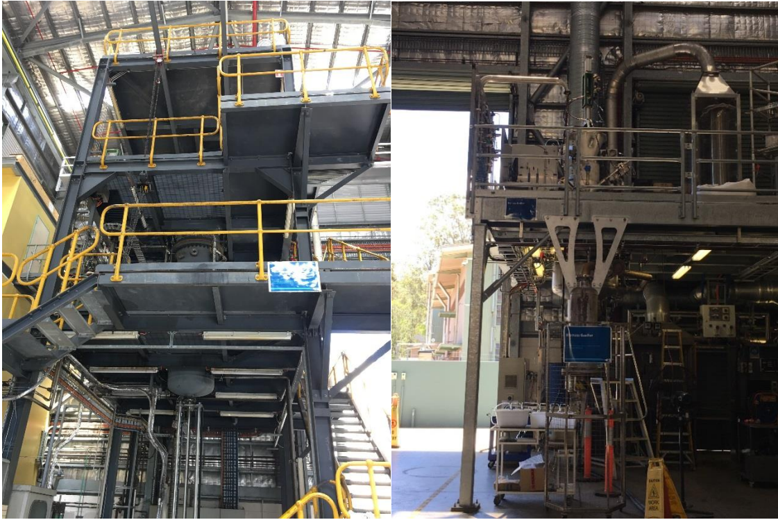
圖11 CSIRO氣化實驗場，左圖為挾帶床氣化爐右圖固定床氣化爐
