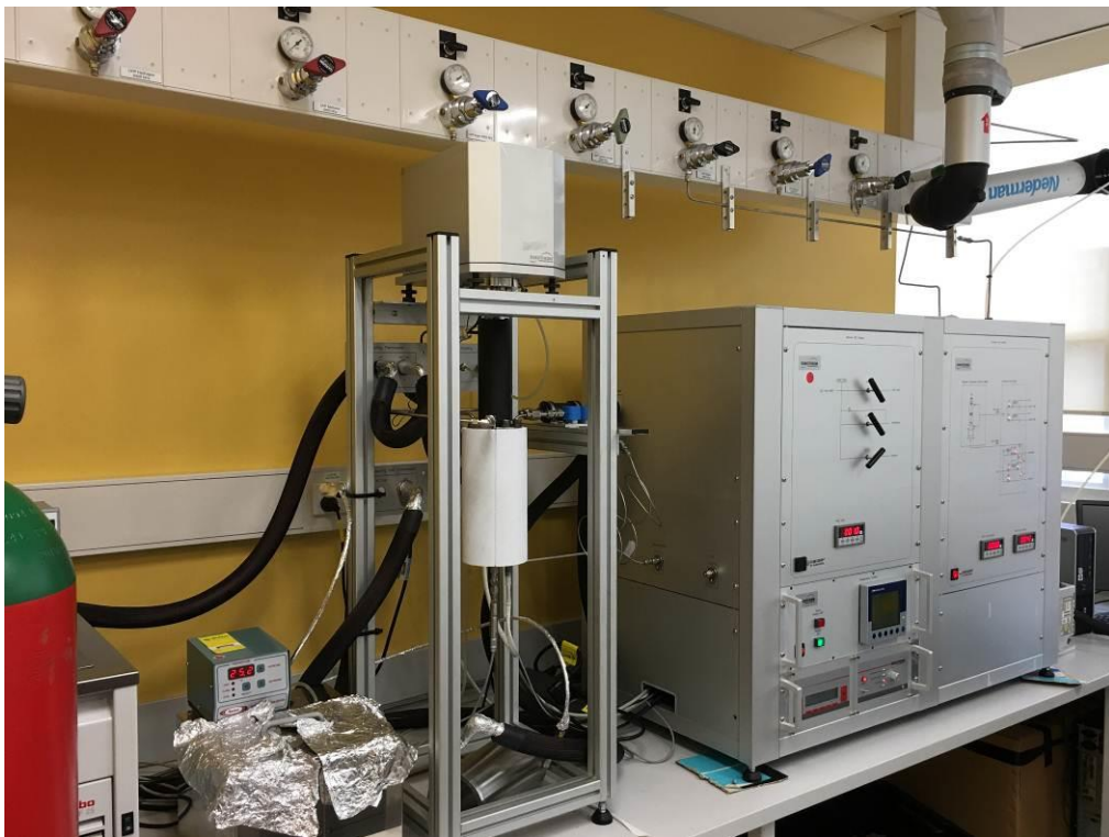
圖 35 高壓高溫可調配不同氣體組成之反應器
