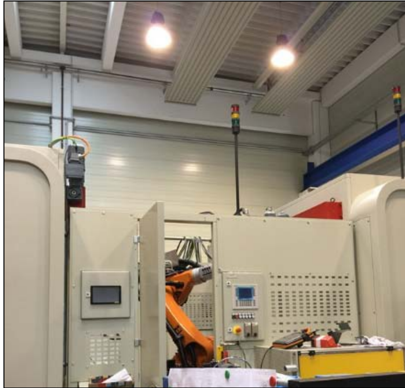
圖 14.6：機械手臂搭配兩台多軸自動加工機(試量產現場)。
