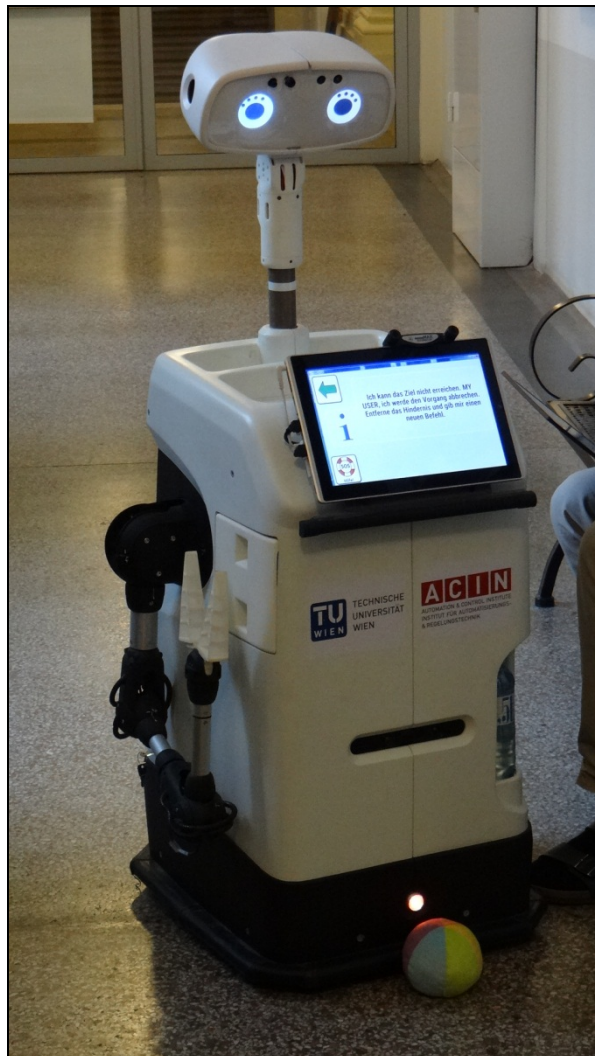
圖 5.11：該機械人具有視覺、X-Y 方向行走、手臂夾持、語音識別等能力。
