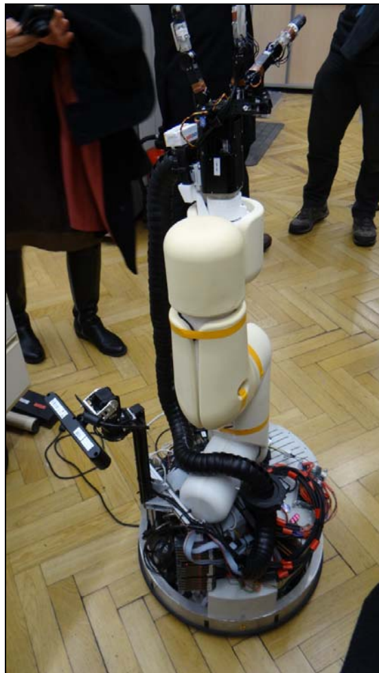
圖 5.13：該機械人具有視覺、X-Y 方向行走、多關節手臂夾持等能力。
