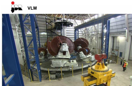
圖 64 JDR's Vertical Lay-up Machine(VLM)
