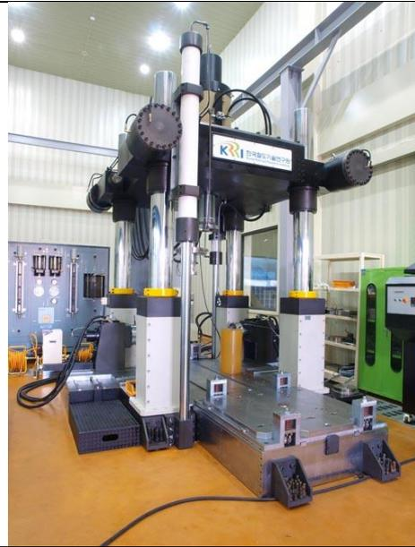
圖 3-1-8 道碴軌道大型三維測試系統
