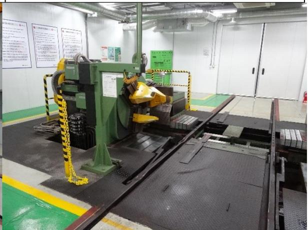
圖 3-4-15 車輪旋削設備現況
