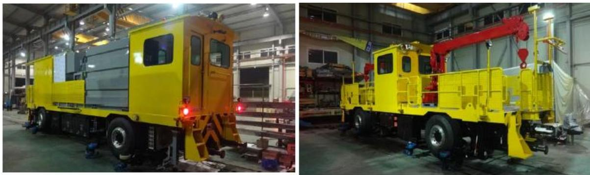
圖3-5-1-1 隧道清洗車(左圖)及軌道維修車(右圖)照片
