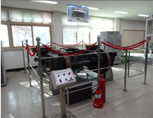
圖 3-2-4 轉向架測試設備
