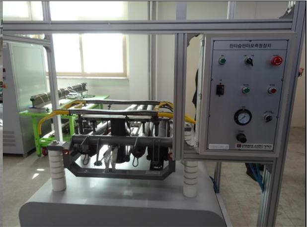
圖 3-2-5 集電弓測試設備
