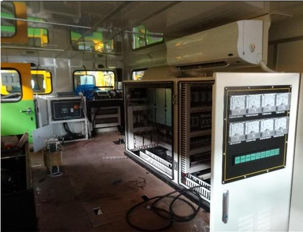
圖 3-5-2-7 工作維修平台車控制盤現況
