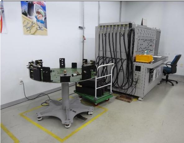
圖 3-4-26 車輛煞車測試檢修設備現況
