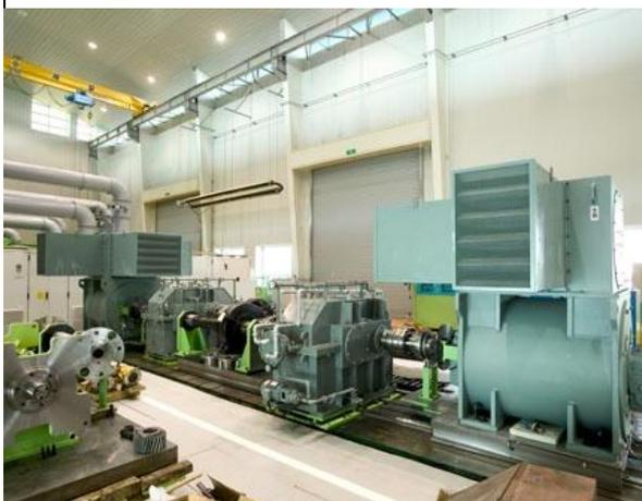
圖 3-1-5 驅動齒輪組測試台
