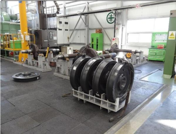
圖 3-4-18 車輪與車軸分解擺置現況
