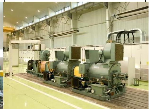
圖 3-1-6 牽引馬達測試台
