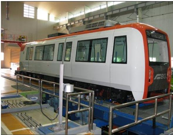
圖 3-1-3 轉向架動態模擬平台
