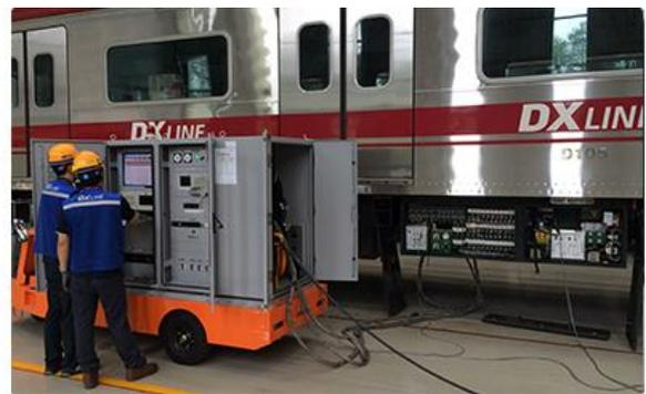
圖3-4-4 光教維修基地車輛日檢作業照片
