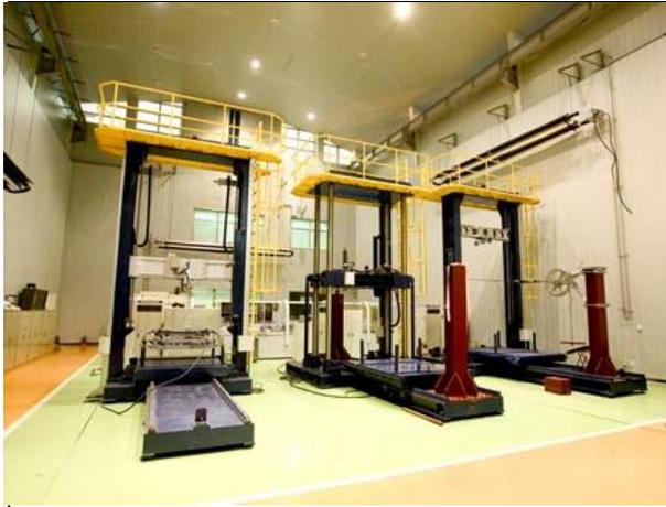
圖 3-1-7 集電弓測試台
