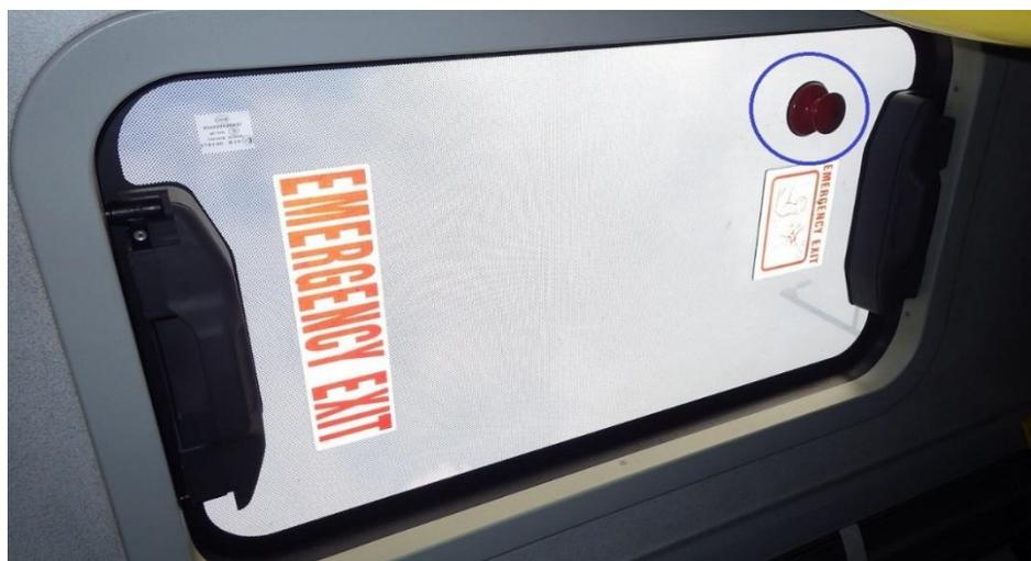
圖 2.17-2 屋頂逃生窗、標示文字、擊破器及擊破說明
