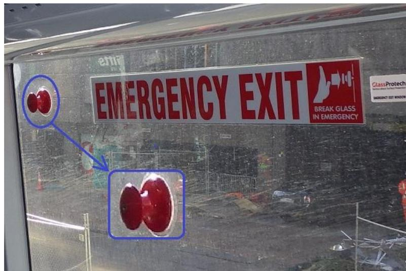
圖 2.17-1 大客車緊急逃生窗、標示文字、擊破器及擊破說明
