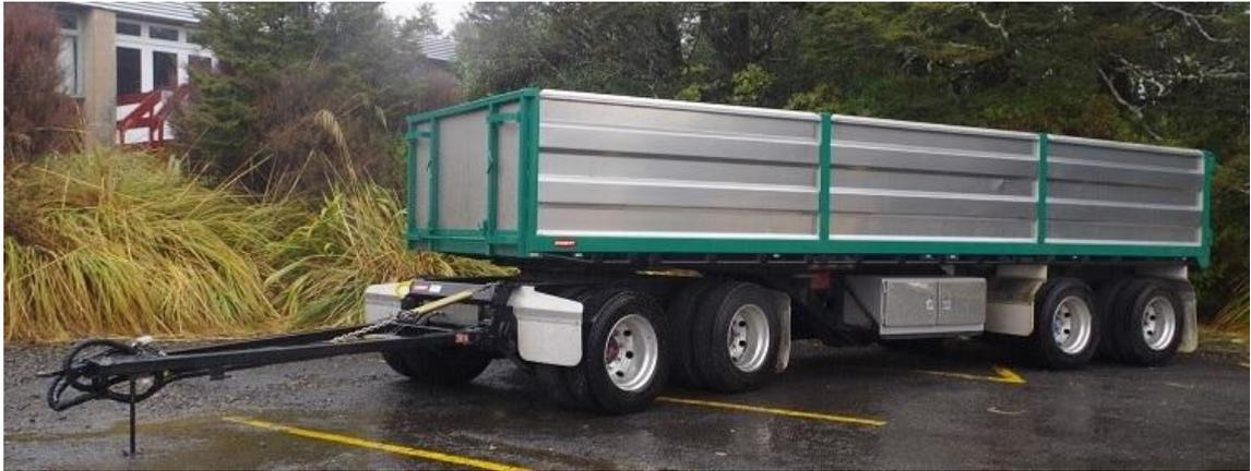
圖 2.21-1 轉換拖架及半拖車組合之全拖車
