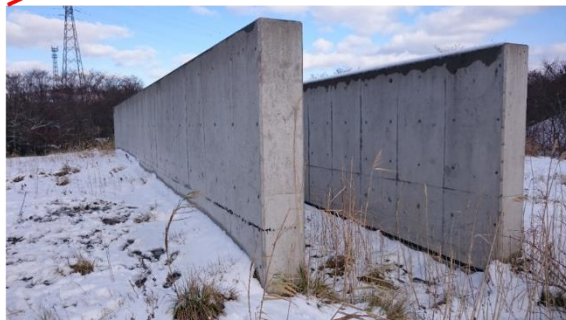
圖 13:L2 低放最終處置場回填用混合土料-膨潤土配比實驗場
