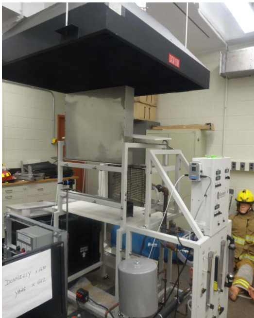
圖 5 壁裝材料延燒性測試裝置
