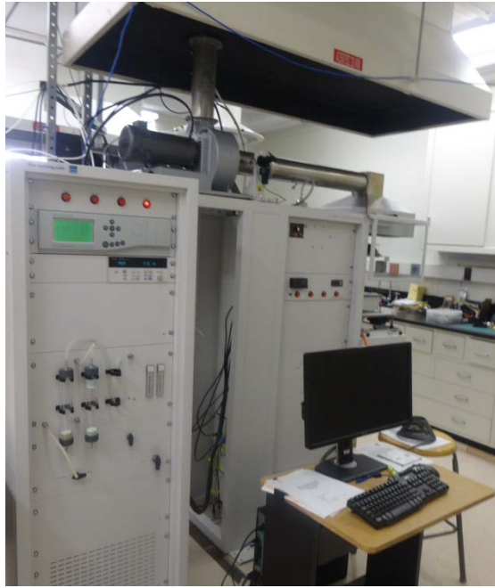
圖 7 圓錐量熱儀熱釋放率測試裝置
