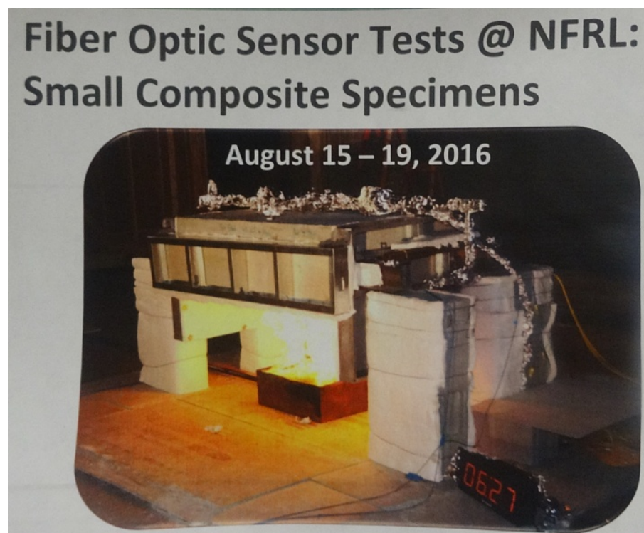
圖 33 埋設有光纖感測器的版加熱試驗
