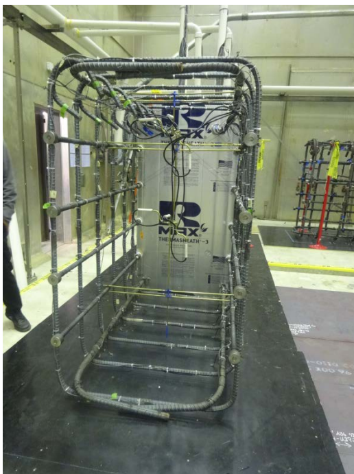
圖42 大型基礎試體製作
