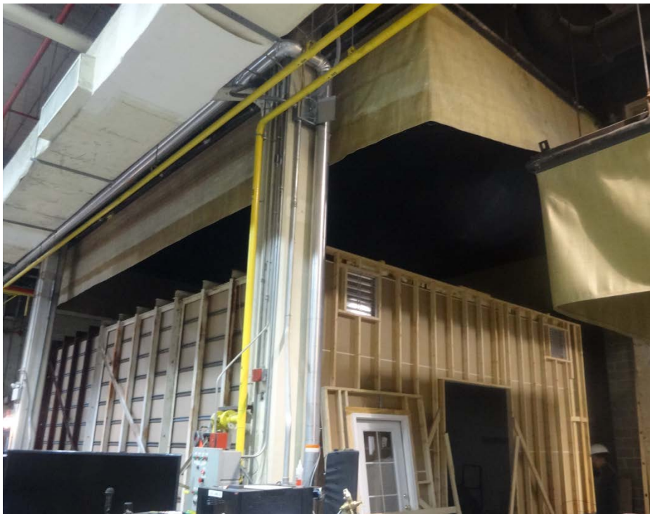
圖 24 木構造實驗屋與上方的 10MW 量熱裝置
