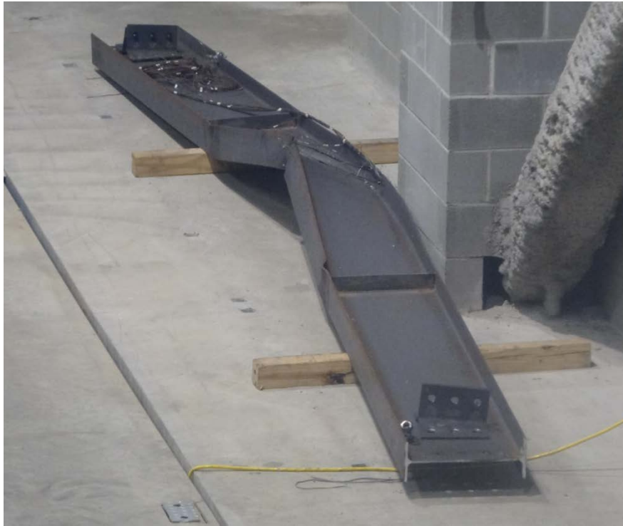
圖 21 受局部加熱後，梁構件試體破壞情形
