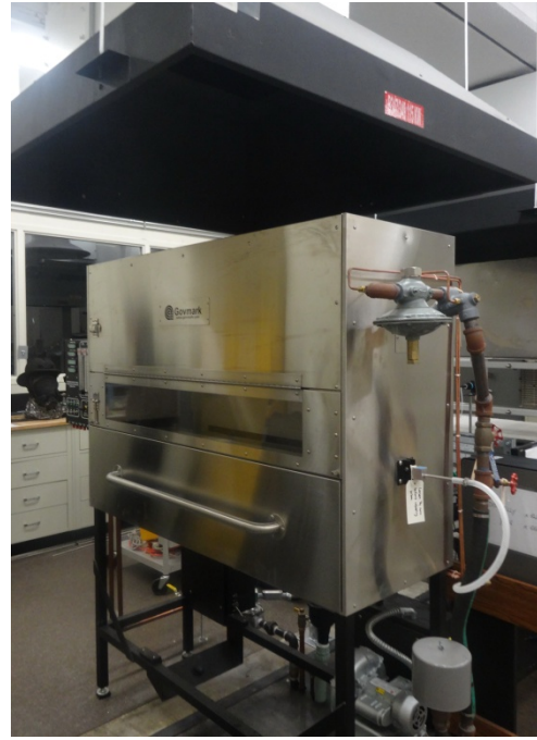
圖 4 地坪材料延燒性測試裝置
