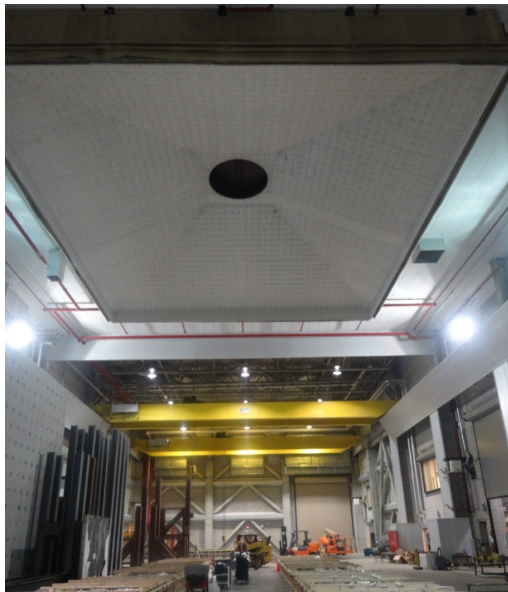
圖 11 20 MW 量熱裝置（安裝於反力牆前，可量測實尺寸建築火災時之熱釋放）
