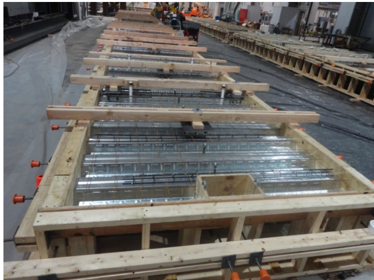
圖 34 含梁複合樓板試體製作
