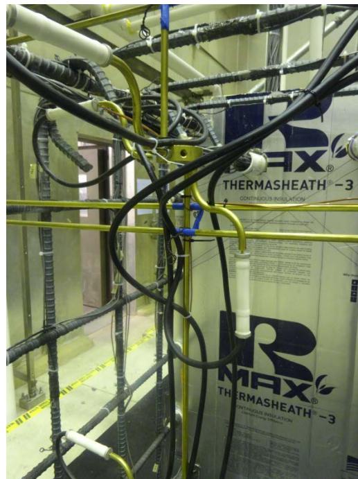
圖43 試體內部量測元件佈設
