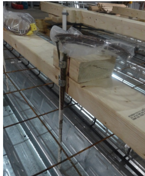
圖 19 試體溫度量測用熱電偶
