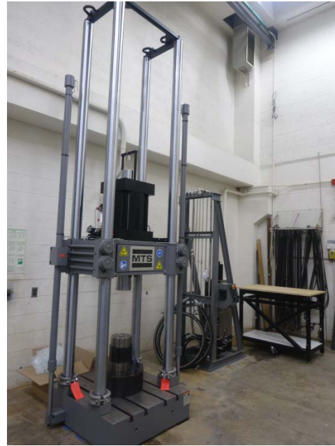
圖41 小型油壓加載系統
