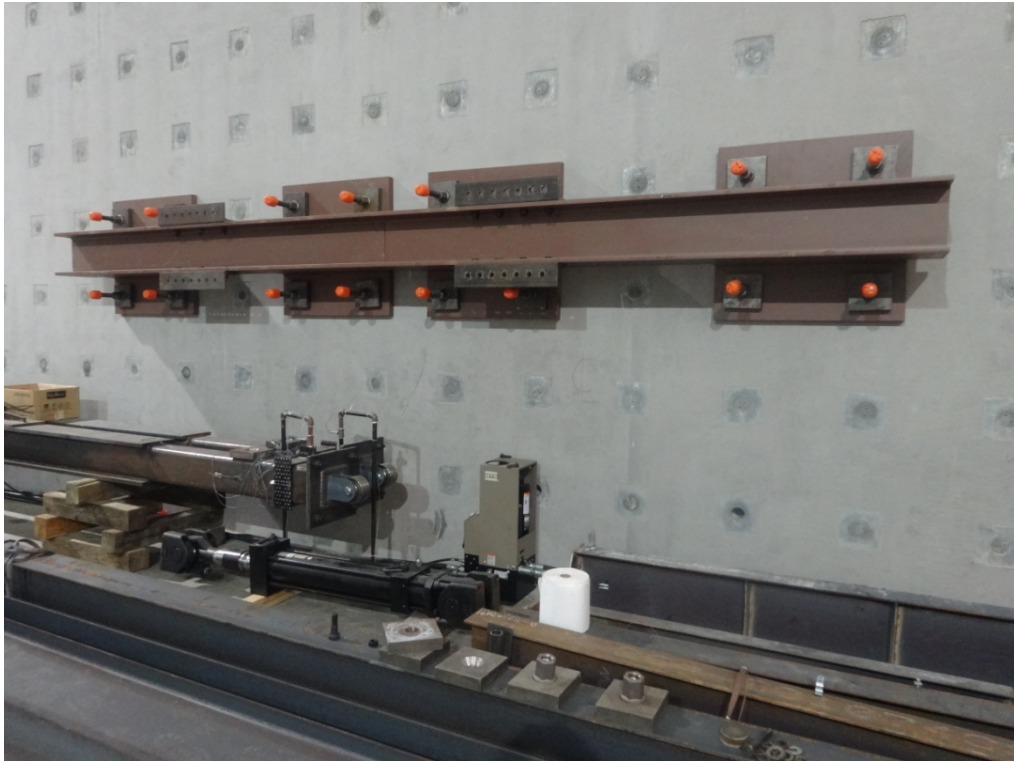
圖 12 拉壓雙向油壓制動器
