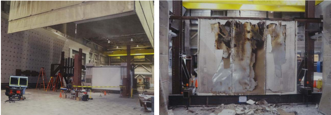
圖36 牆系統受側向力實際火源加熱試驗
