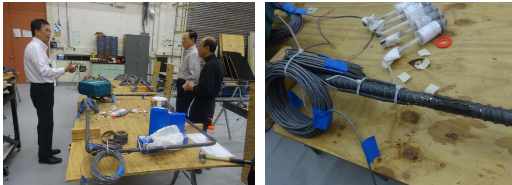
圖39 箍筋應變計施工介紹
