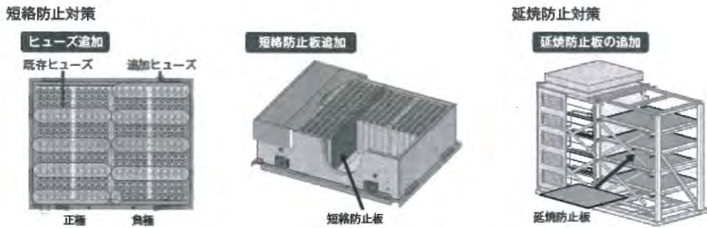
圖 6 NAS 電池避免火災再發生措施
