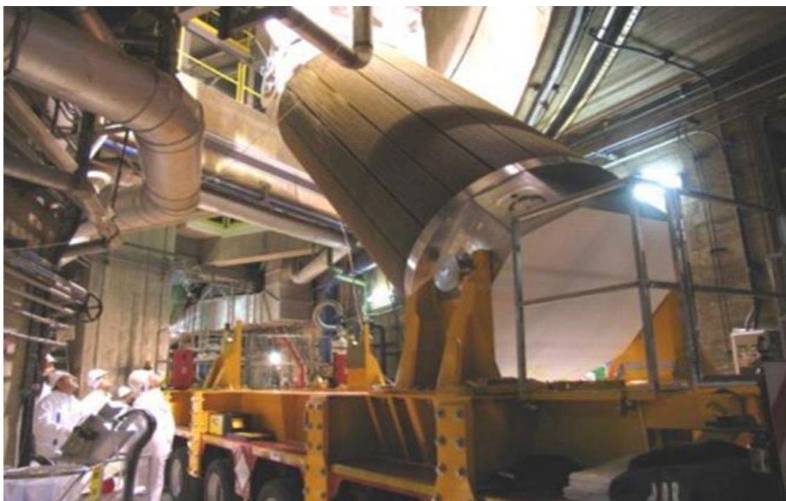
圖16、 燃料運輸桶吊掛過程
