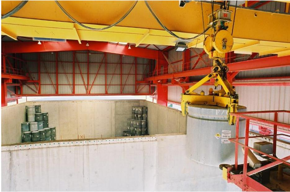
圖五十一、CSA 配置之移動式操作棚及吊掛裝置
