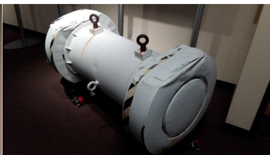
圖十三：容器墜落實驗結果
