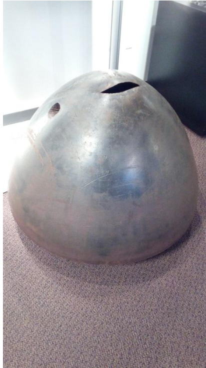
圖十一：反應器壓力槽底部實驗結果
