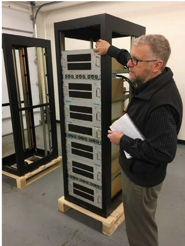
附圖 6 東沙島剖風儀發射機含 6 部 2kw 功率放大器
