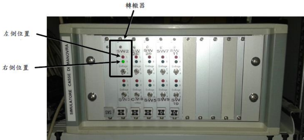
圖 2.1.27 出廠測試- Point Machine Simulator 轉轍器模擬器 現場 實體設備照
