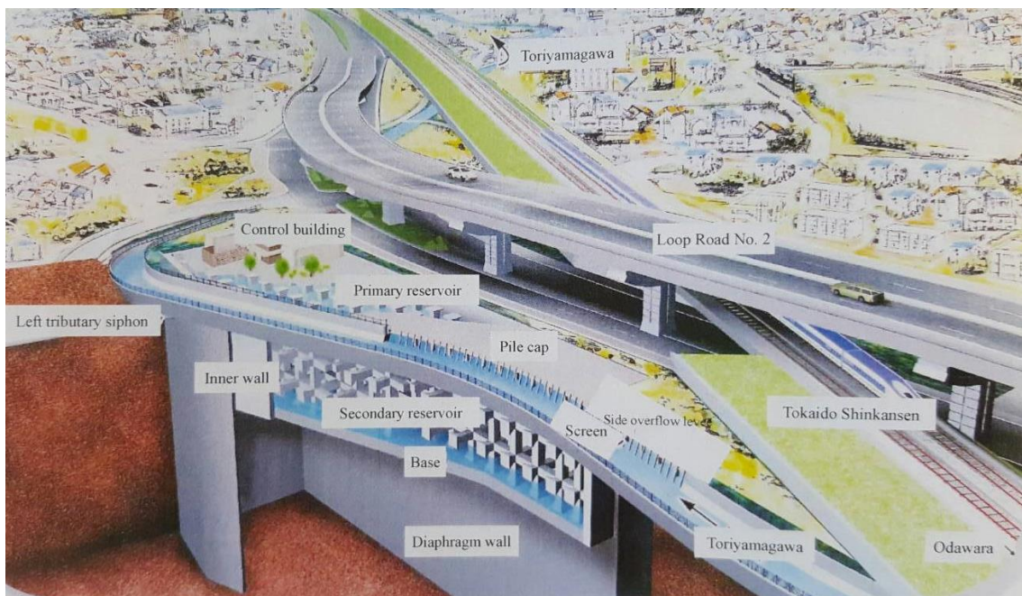
圖 33：鳥山川地下遊水地的結構示意圖
