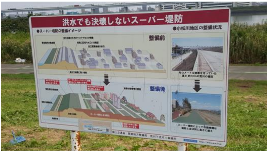
圖 16：高規格堤防整備前後的說明
