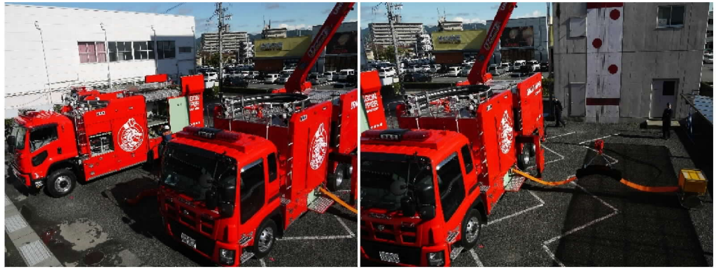
圖 66 2 輛大型抽水車及架設連結情形
