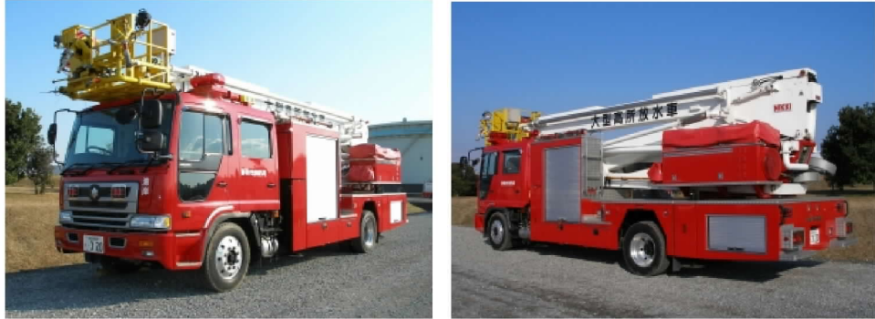
圖 64 灣岸消防署大型高所放水車
