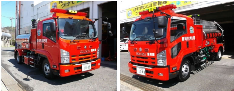
圖 65 灣岸消防署泡沫原液搬送車
