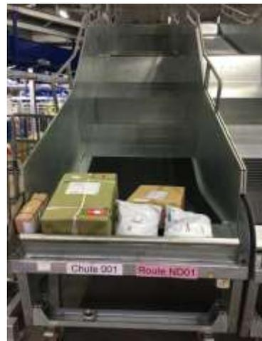
圖 8：出貨滑道：滑道末端可人工伸縮，若包裹量過大，集貨區空間不足，可將滑道拉長，容量可增加 66%。
