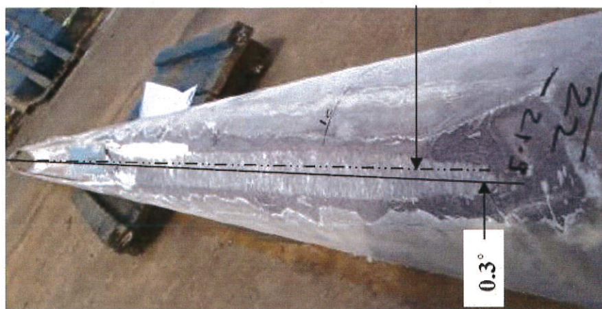
圖 3、在工廠內以開窗工具下入井底完成開窗後，與計畫線偏移誤差僅 0.3 度。
