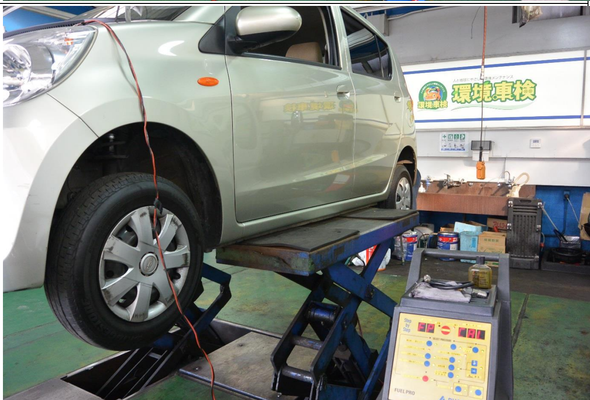
環境車檢：SUNAUTAS 為美國 Advantage Engineering 亞洲獨家代理商，利用此 2 套設備可分別清除潤滑系統、燃料系統之雜質及積碳，可明顯改善老車排氣與燃燒效率。
