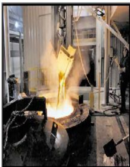
圖 9 低放射性廢棄物金屬經由鎔鑄減容製成金屬鑄錠作為屏蔽再利用
