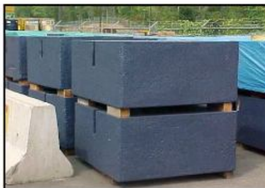
圖 9 低放射性廢棄物金屬經由鎔鑄減容製成金屬鑄錠作為屏蔽再利用
