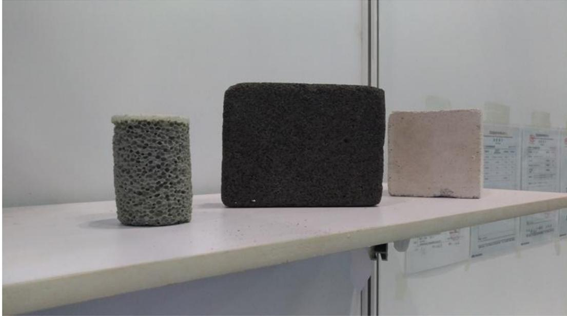
圖 6 污染物去除後，重製而成之磚窯成品
