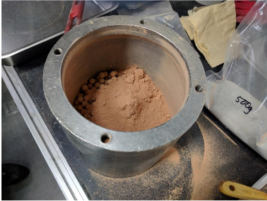
圖 66 盛裝鋼珠的研磨桶槽
