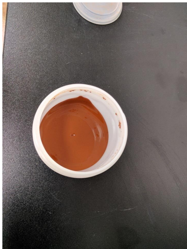
圖 20 經THINKY攪拌機拌合後的均勻無機聚合膠體
