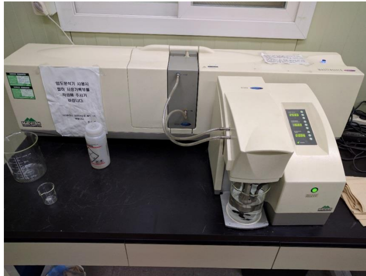
圖 61 雷射粒徑分析儀Mastersizer 2000
