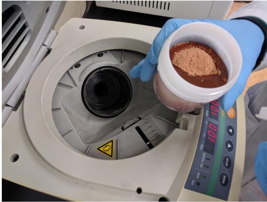
圖 19 MK100偏高嶺土摻入鹼激發液後以THINKY攪拌機拌合
