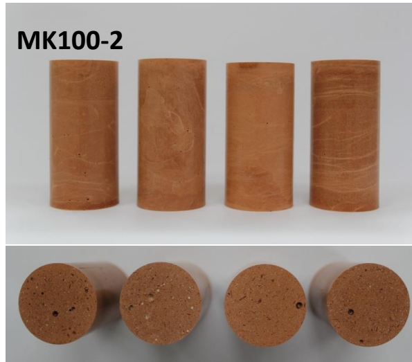
圖 25 MK100-2拆模試體之側視及俯視圖
