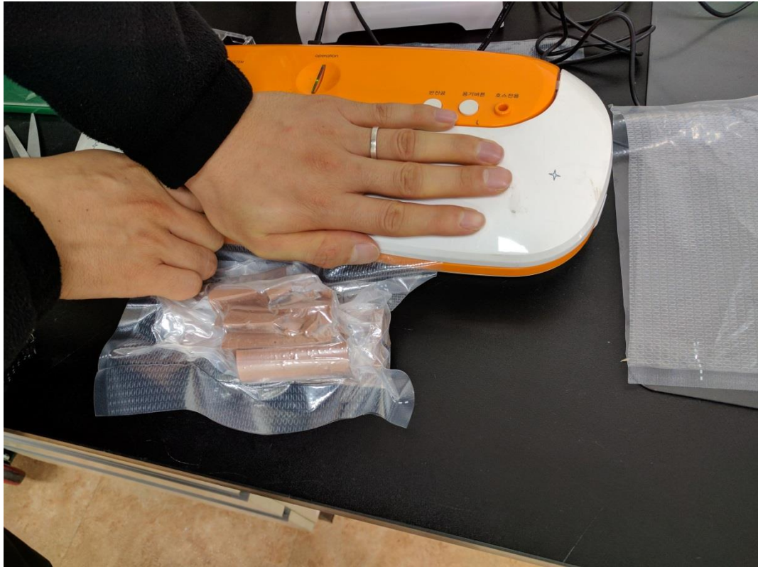
圖 35 真空包裝機處理保存抗壓強度試驗測試後的破碎試體
