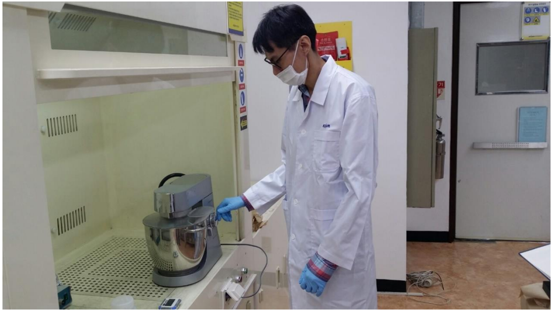
圖 15 使用一般型攪拌機混合攪拌無機聚合固化體合成材料
