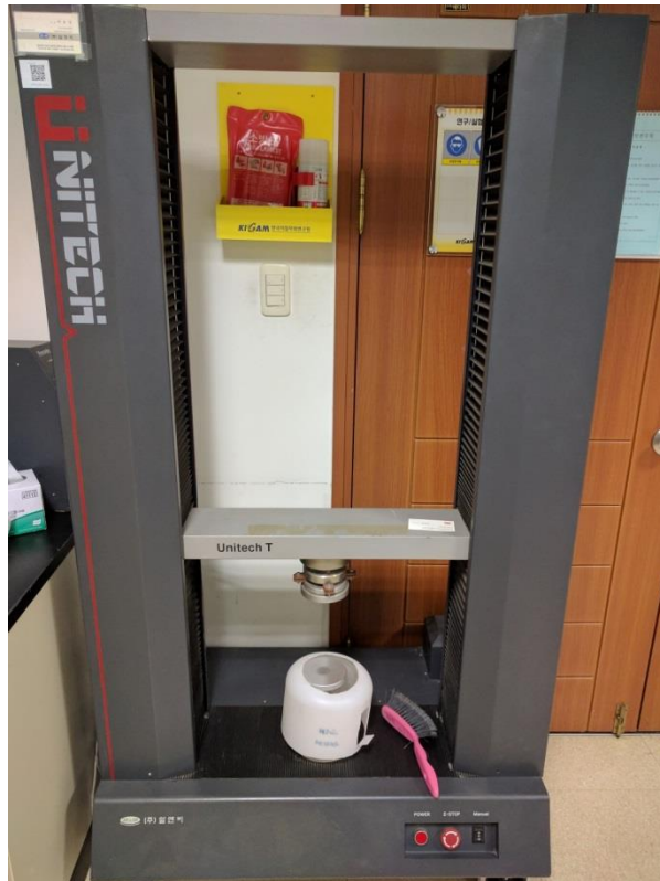
圖 31 抗壓強度試驗機裝置
