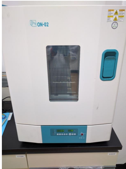
圖 23 直徑29 mm,高58 mm的標準試體置於70 °C烘箱內養護24小時
