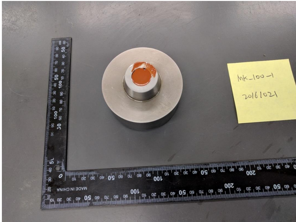
圖 27 無機聚合膠體灌填至迷你坩度桶
