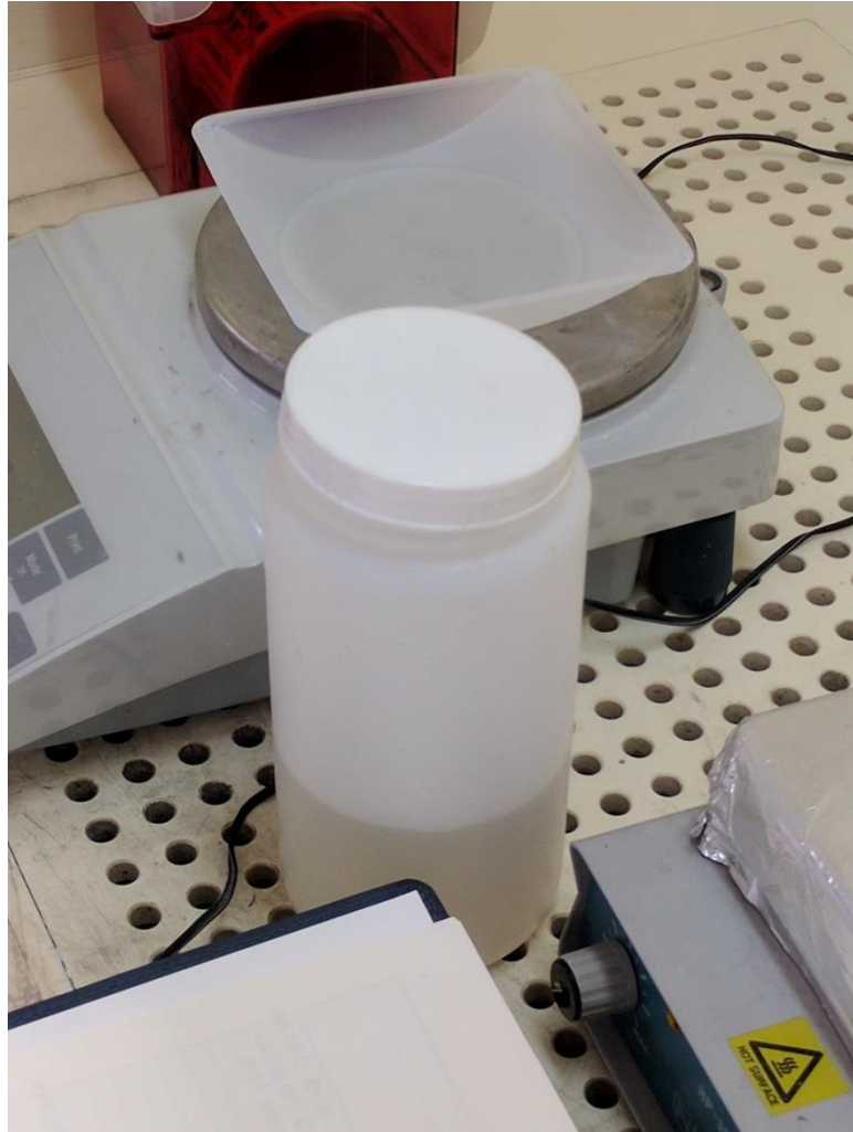
圖 18 用於調製鹼激發液的鈉水玻璃(Sodium silicate solution)
