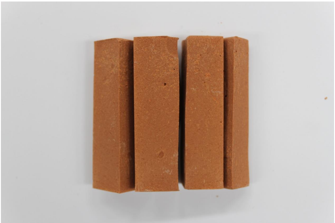
圖 34 MK100-2 抗壓強度測試破碎斷面
