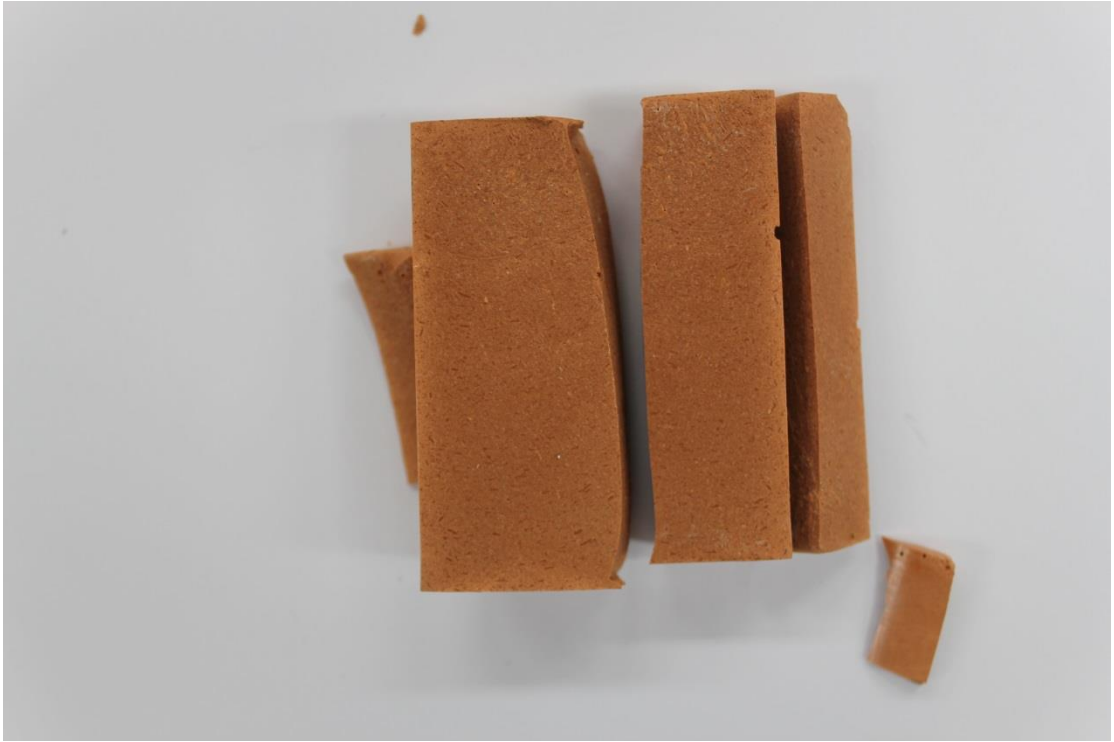
圖 33 MK100-1 抗壓強度測試破碎斷面
