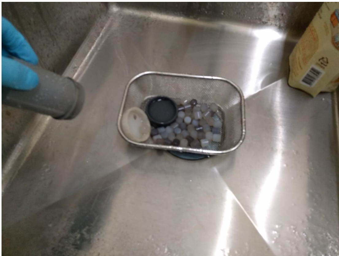
圖 54 用以研磨粉體的研磨粒
