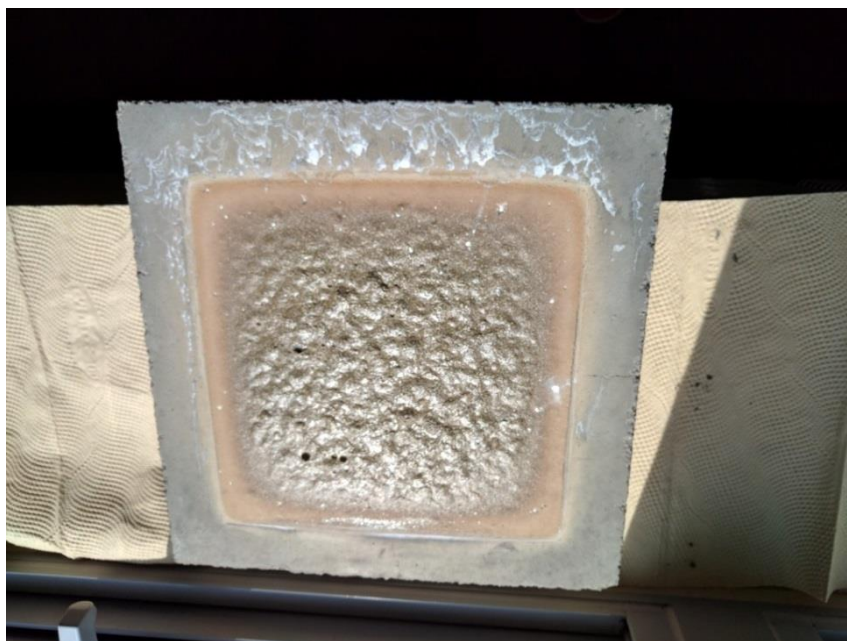
圖 68 韓國地質資源研究院開發可耐950°C 高溫的無機聚合耐火建材
