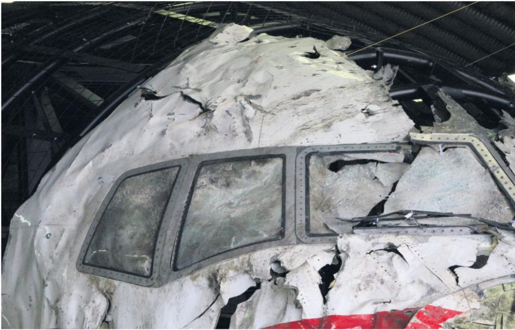
圖 3.15 MH17 航班之機頭殘骸重建圖（包含孔洞與跳彈痕跡）
