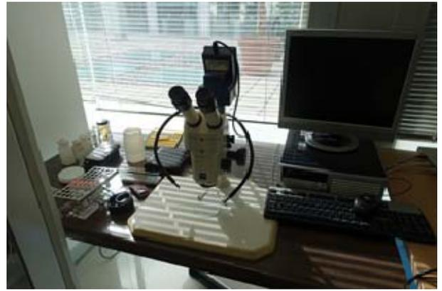
耳石數位影像攝製用顯微鏡系統
