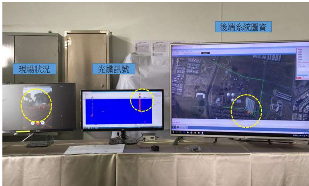
圖 33 模擬電纜事故後系統狀況
