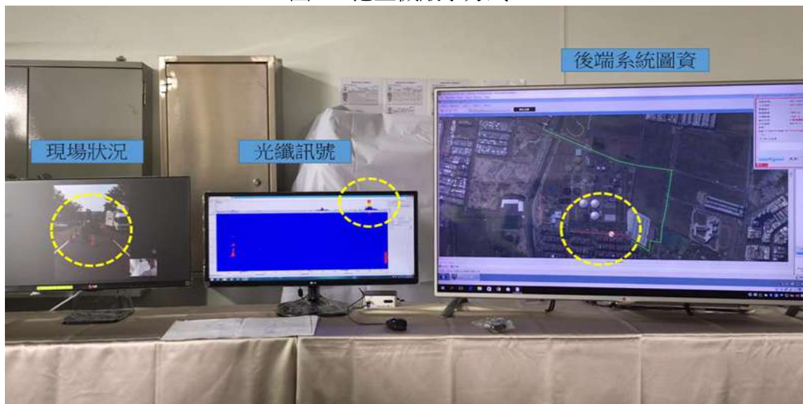
圖 31 模擬道路挖掘後系統狀況
