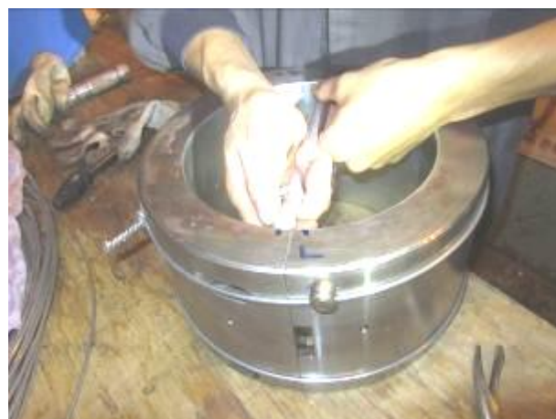
照片 16：軸承內徑量測
