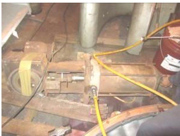
照片 15：燃油逆止閥進行測試
