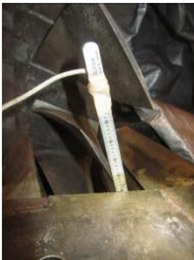
照片 9：空壓機動葉徑向間隙量測
