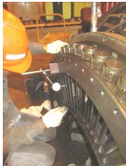
照片 10：IGV 齒隙量測
