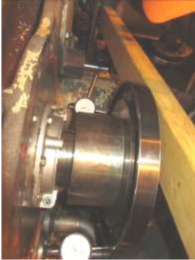
照片 19：量測齒輪箱軸向間隙
