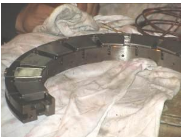
照片 17：推力軸承整理檢查
