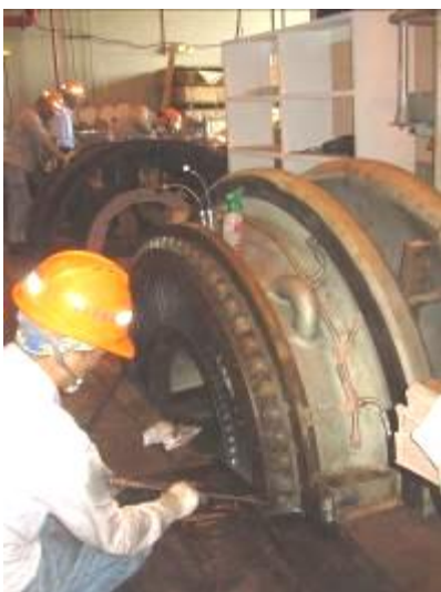
照片 11：IGV 齒隙清理
