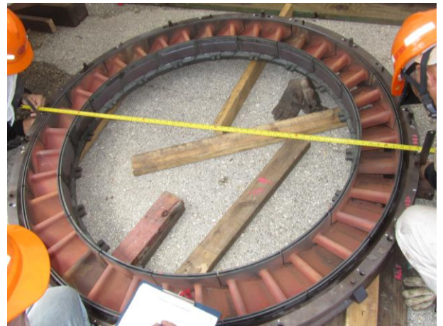
照片 4：靜葉環量測真圓度
