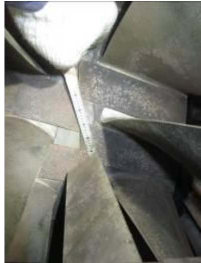
照片 8：空壓段轉子與靜葉片間隙量測
