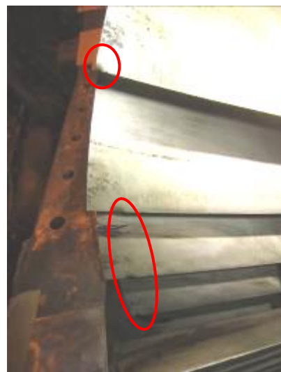
照片 6：空壓第 0 級動葉 4 只凹陷瑕疵
