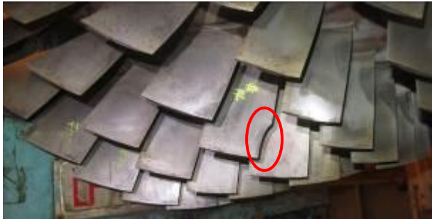
照片 7：CT2 空壓第 2 級#14 動葉片缺陷磨除
