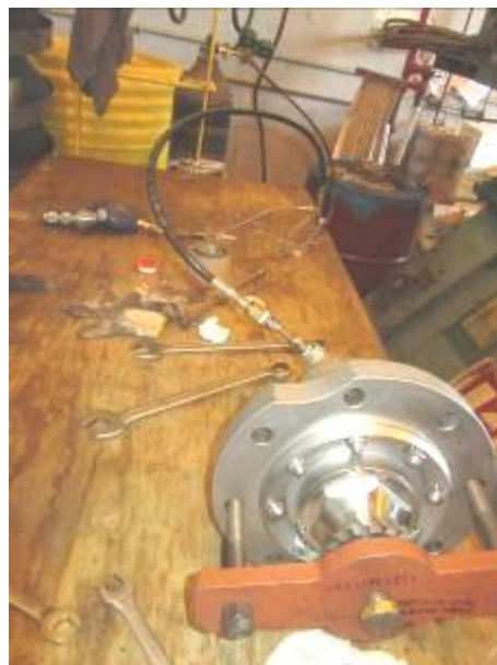
照片 14：燃油噴嘴試壓
