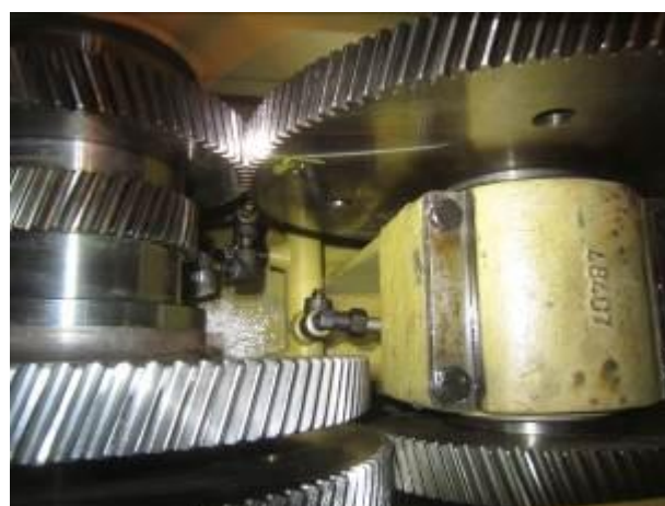
照片 18：起動齒輪箱開蓋檢查
