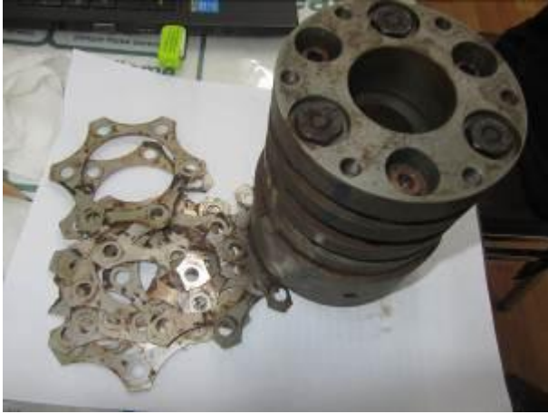
照片 25：輔助潤滑油泵聯軸器墊片破裂
