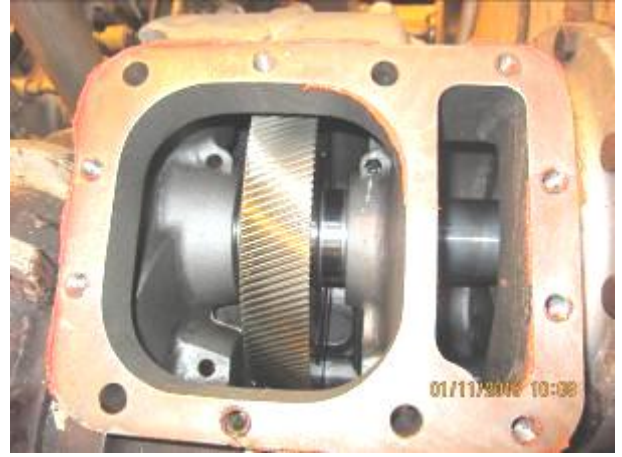
照片 26：開蓋檢查主霧化空壓機
