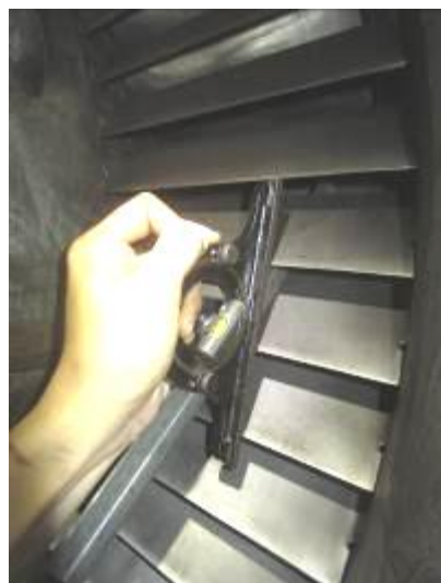
照片 12：IGV 開度角度量測
