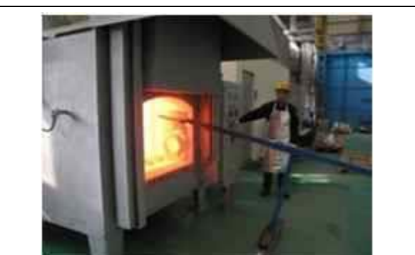
圖 13 陶製殼模澆鑄前熱處理。
