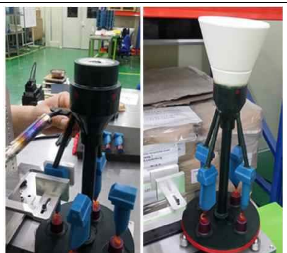
圖 10(2) 蠟模組樹，黑色管子用以建立澆道 (runner)，亦為低熔點材質。
