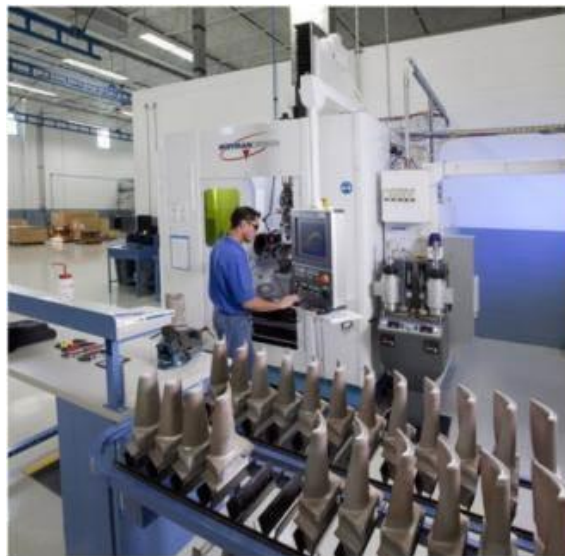
圖 51 雷射覆銲設備。
