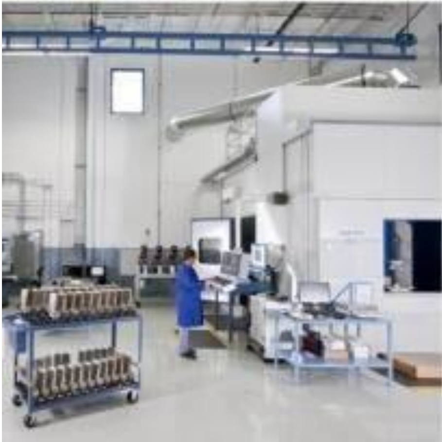
圖 54 噴鍍設備，使用 HVOF 及 APS 兩種製程。
