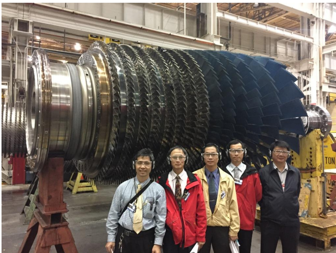
圖 34 GE Gas Turbine 工廠內的氣機空壓段轉子。
