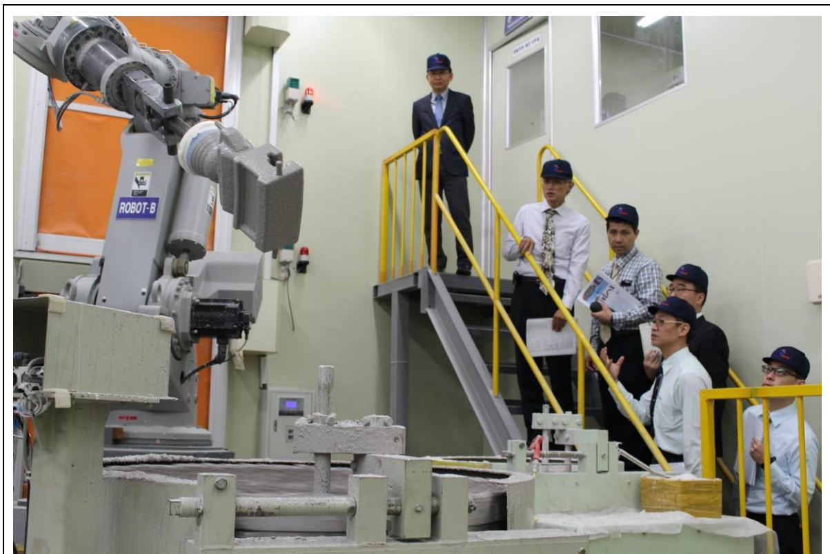
圖 22 Sung-II Turbine 工廠陶模成型製程，自動化沾漿淋砂設備。
