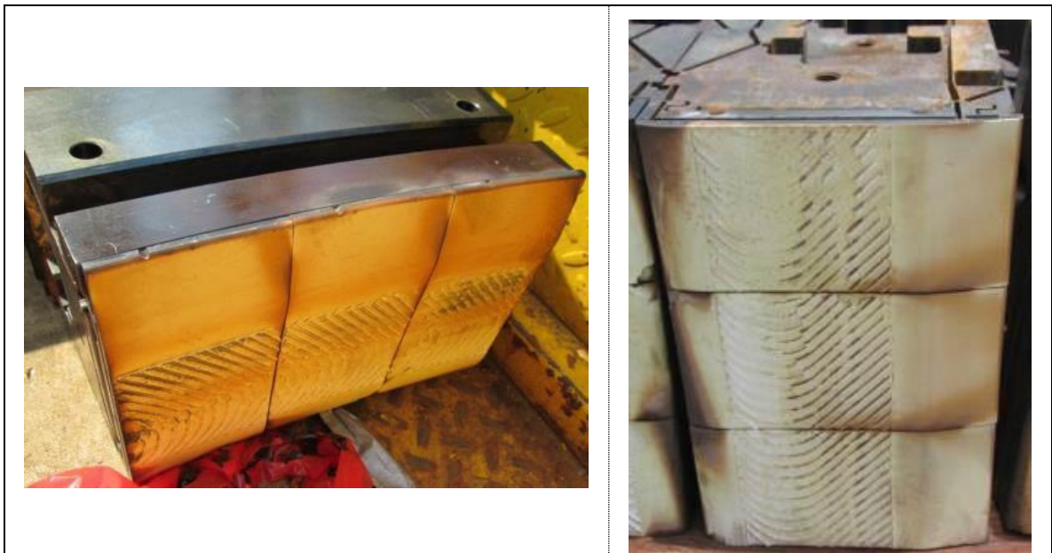
圖 33 ring segment 上的 abradable coating 並未出現整片剝落，其技術可見一斑。
