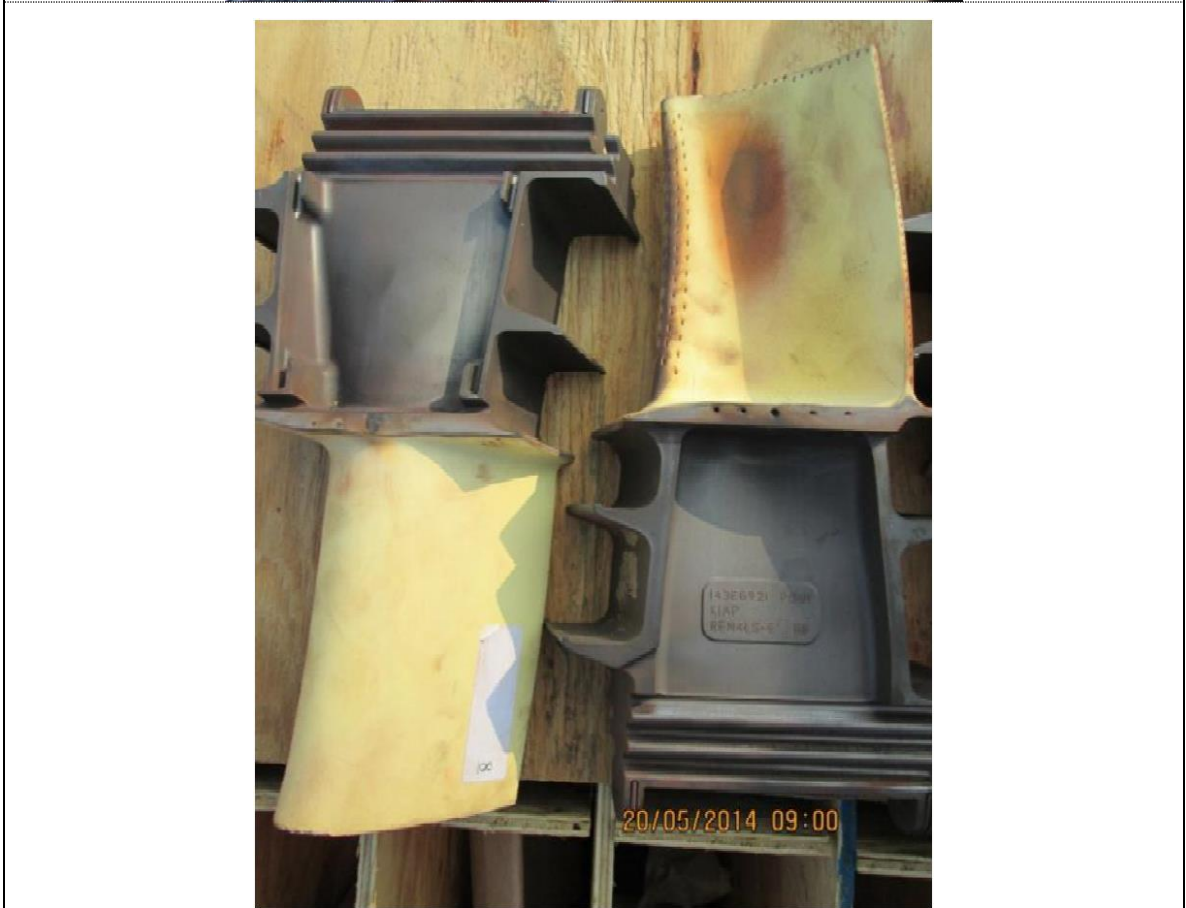
圖 26 GE 7F 系列氣機第一級動葉片運轉後照片。在 F 等級裡，運轉週期優異。
