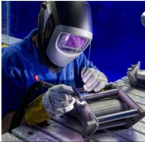
圖 50 手工氬銲修補，使用了尺寸精準的夾治具。
