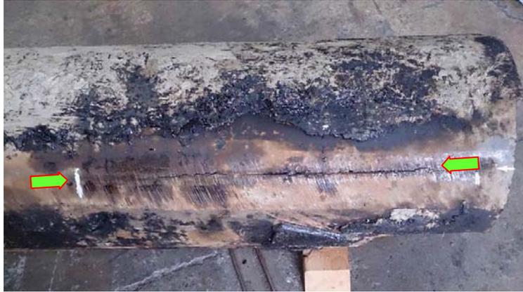
圖31 裂縫所在位置的表面有明顯的鏟傷痕跡，此區鏟傷寬度9cm至11cm，箭頭之間為鋼管製程之焊道所在
