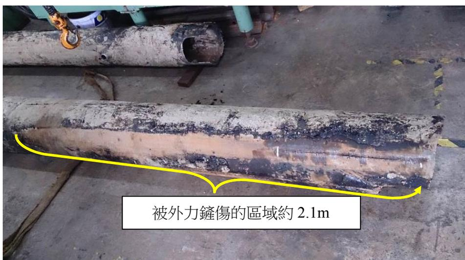
**圖30** 地下管線裂縫總長約63cm，裂穿部分之長度53cm，屬於非爆開型態之裂縫，外表面遭外力鏟傷之長度約2.1m
