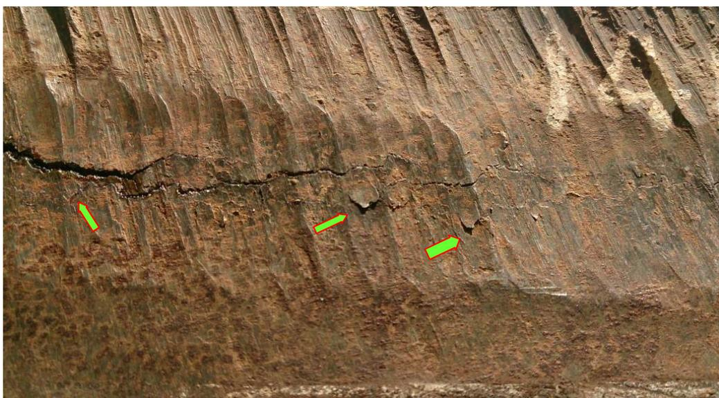
圖33 地下管線遭受鏟傷之外表面有若干摺層，如箭頭指示
