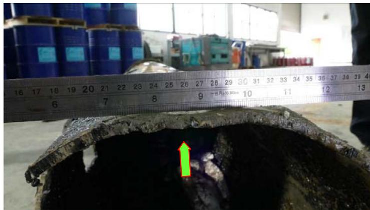
圖32 被鏟傷處之地下管線直徑有約1cm之凹陷，如箭頭所示
