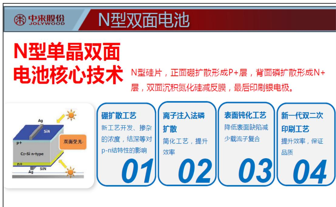
圖 48、N 形單晶雙面太陽能電池之製程原理
