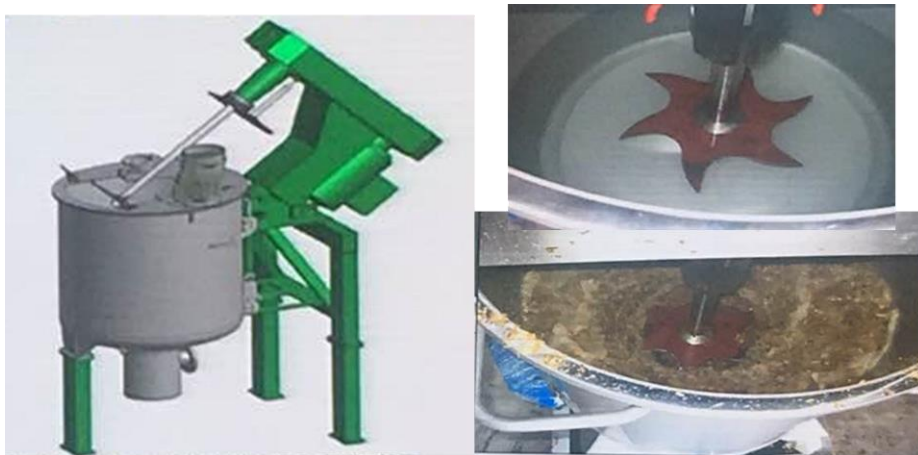
圖十六 專利預處理罐 Kreis-Dissolver 及內部齒盤(EnviTec, Germany)
