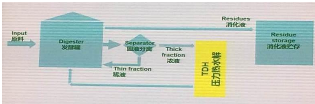
圖十七 Pressurized thermal hydrolysis 壓力熱水解技術 (EnviTec, Germany)
