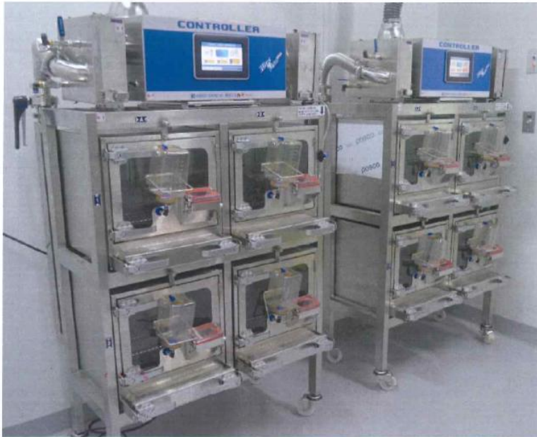
圖 7. 兔子與雪貂用之隔離籠，因飼養籠較重，故另需設計可升降之推車，以便於操作。
