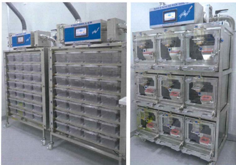
圖 6. 左方圖為拋棄式小鼠用生物安全第三等級隔離籠；右方圖為天竺鼠用隔離籠。
