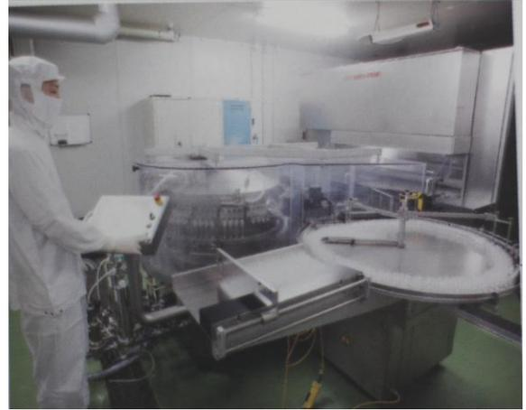
疫苗瓶清洗滅菌分裝自動化機器
