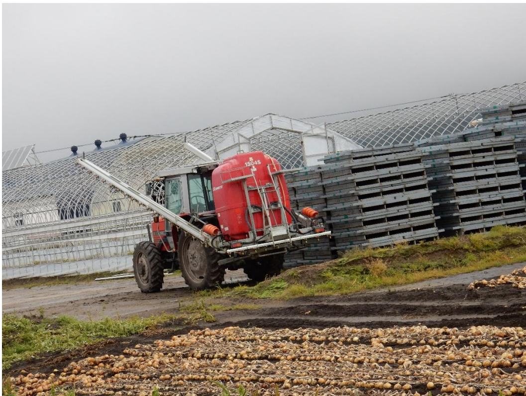
曳引機附掛洋蔥噴灌機及折疊後的洋蔥收集籠
