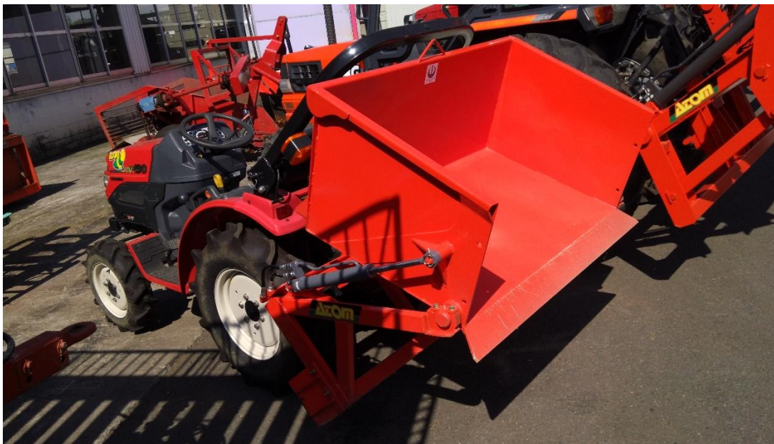
ATOM 農機生產的曳引機附掛式貨斗，可以在田間搬運收穫後的農產品
