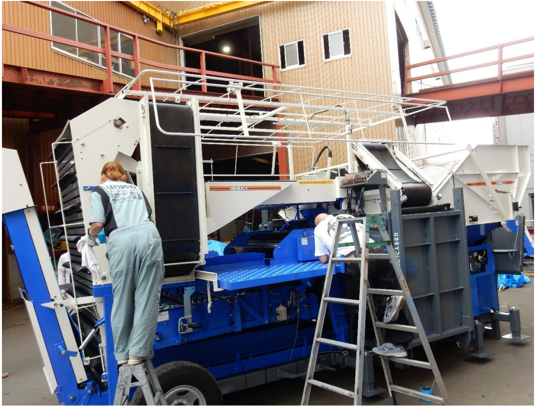
正在塗裝中的 ISEKI 定置式洋蔥莖葉切斷機
