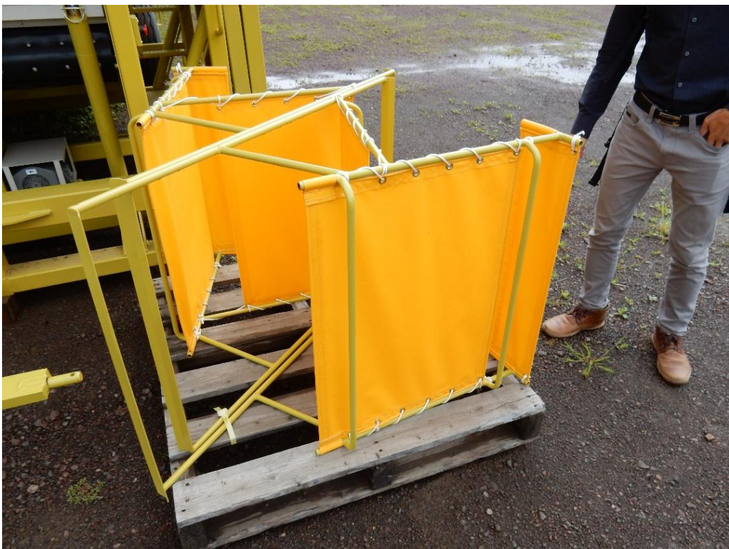
洋蔥收穫緩衝架，可緩衝洋蔥自收穫機構落入收集籠的衝力，以避免洋蔥受傷
