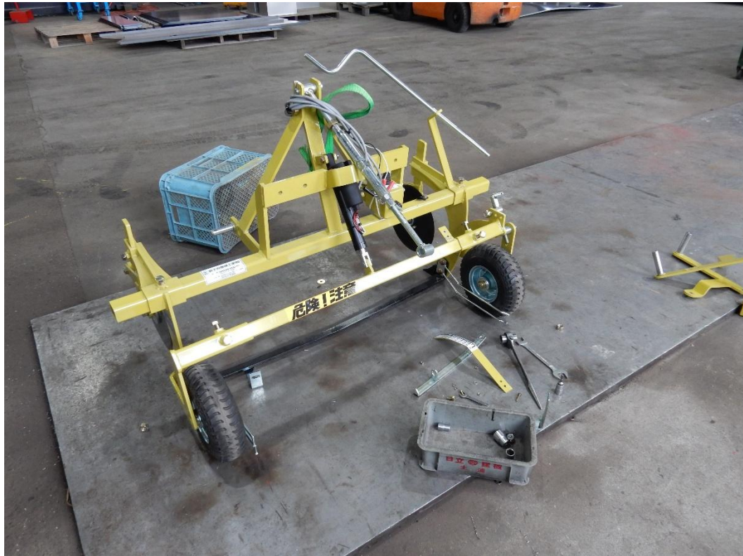
訓子府機械工業株式会社生産の附掛式洋蔥挖掘機
