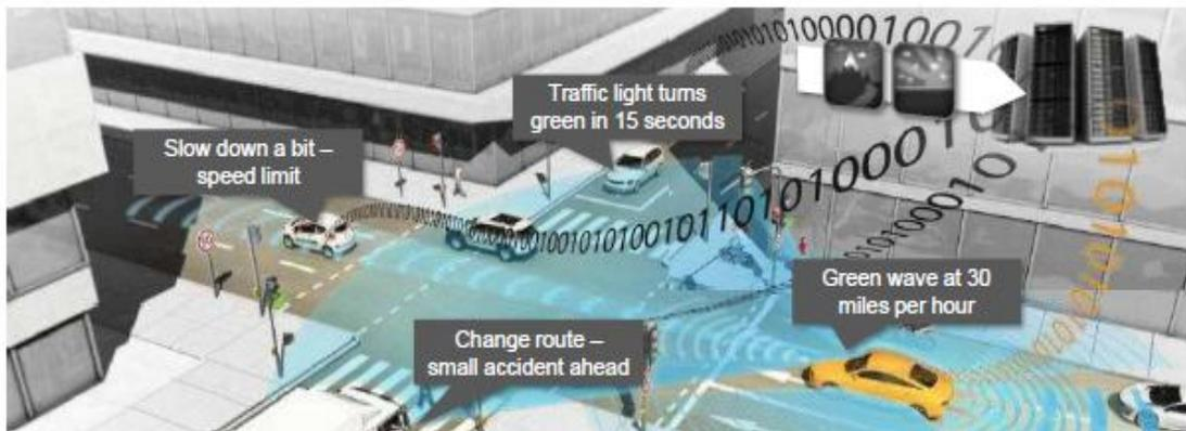
圖 2.44 車輛透過車載設備與路側設備來提升行車安全
