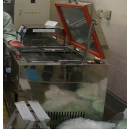
圖 4-5 加工設備-液態酒精介質凍結機
