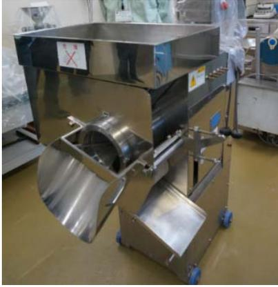
圖 4-4 加工設備-去皮及魚肉採取機
