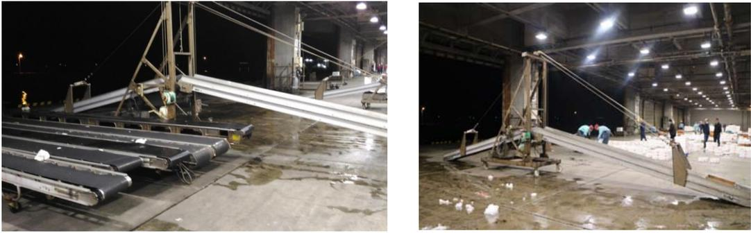
圖 5-8 沿近海小型漁船用之電動輸送帶(左)與斜臂支架(右)。
