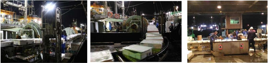
圖 5-9 大型拖網船用長距離電動輸送帶
