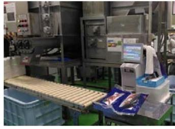
圖 6-11 電子重量計測記錄機
