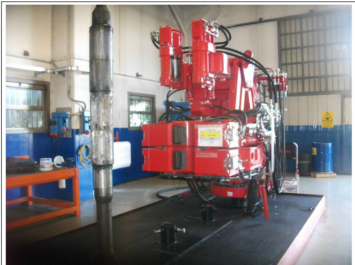
自動上、退扣設備
