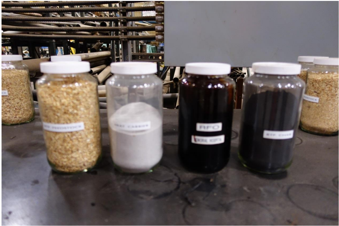
圖五、進料與產品(由左而右依序為原料、床砂、生質裂解油、焦炭)
