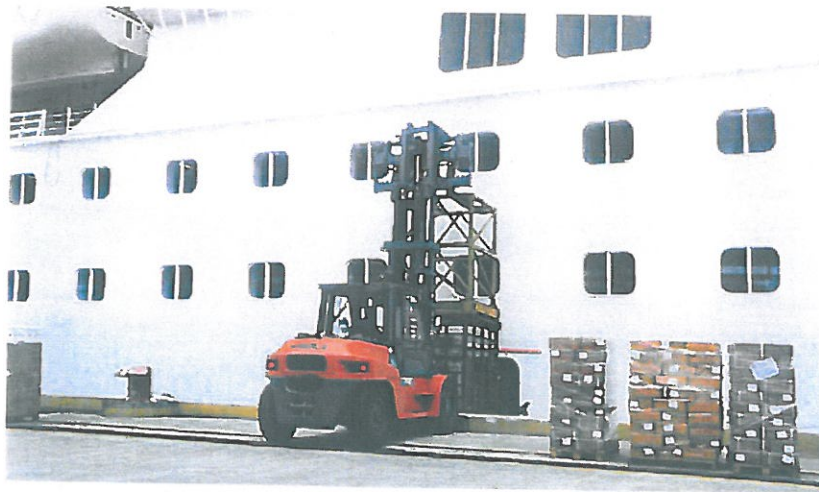
圖 7 補給艙口低於碼頭面之作業方式
