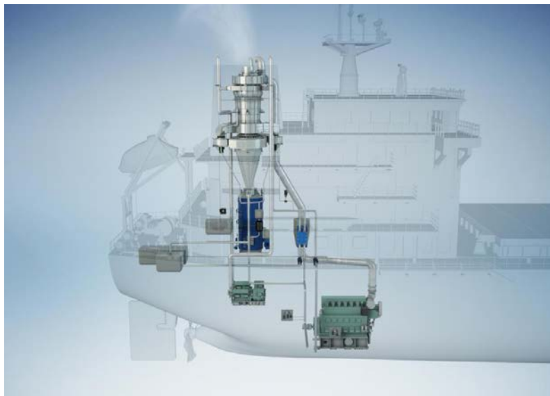
圖 19 空氣過濾器(Scrubbers)，資料來源：課程講義
