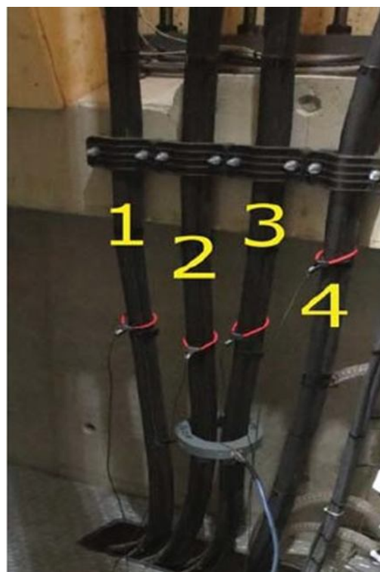
圖 6-2 電流探棒配置於多兆瓦之 風力發電機的電力線纜周圍
