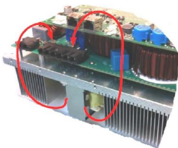
圖 13-1 充電器電源模組之功率電感直接對 AC 連接器造成電磁干擾
