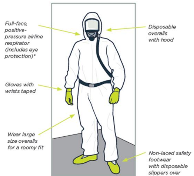
圖十六、Belgoprocess 含石綿廢棄物之拆除作業人員防護著裝示意
