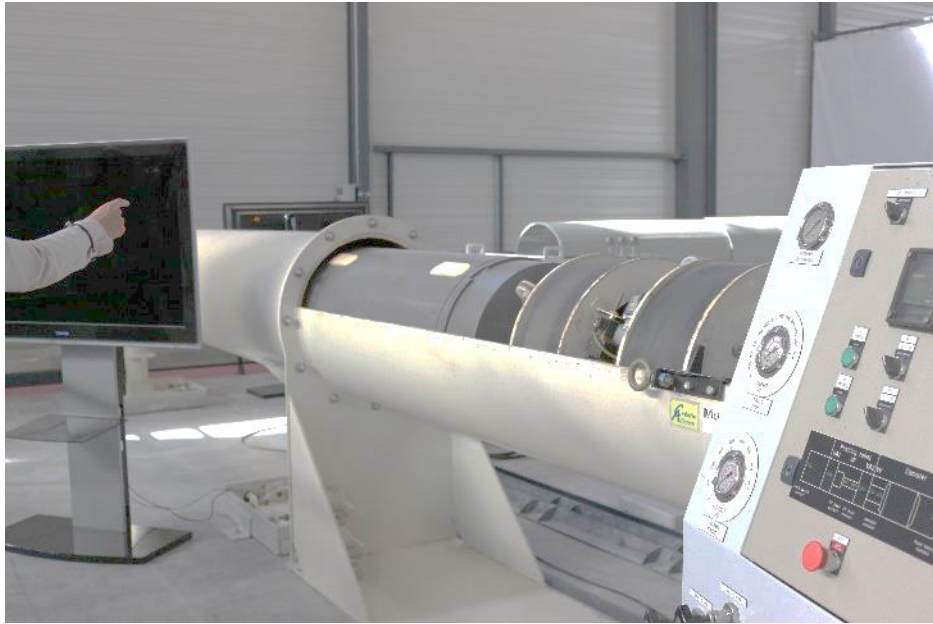
圖 30 廢棄物罐送入處置坑之傳輸設施
