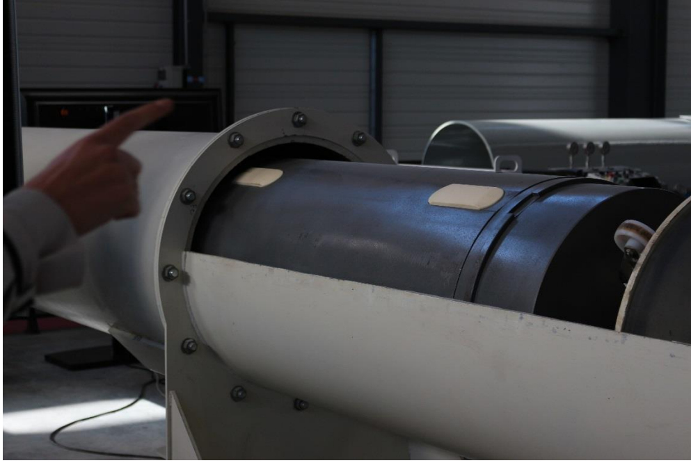
圖 34 外包裝外壁上之陶瓷墊片
