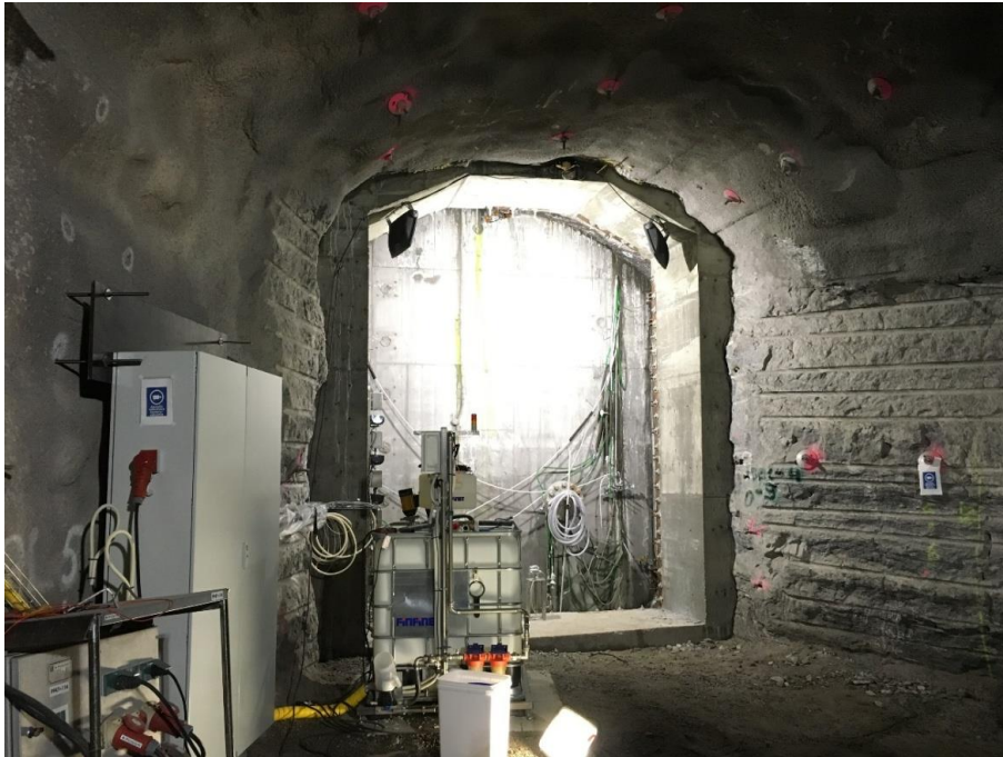
圖 13 全尺度封塞及坑道封閉試驗
