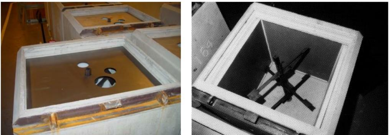
圖 27:水泥固化 IER 之拋棄式攪拌器
