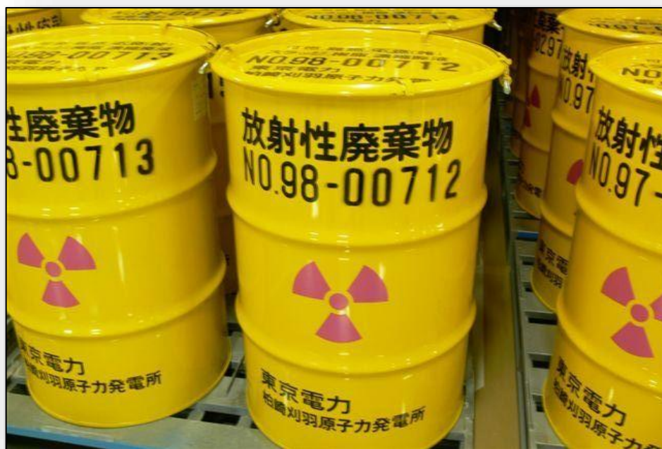
圖 1：日本低放射性廢棄物使用之 200L 鋼桶容器
