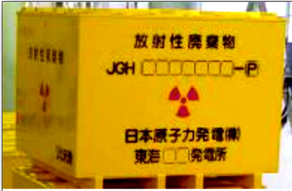
圖 2：日本放射性廢棄物使用之 1.3m×1.3m×0.9m 鋼箱容器
