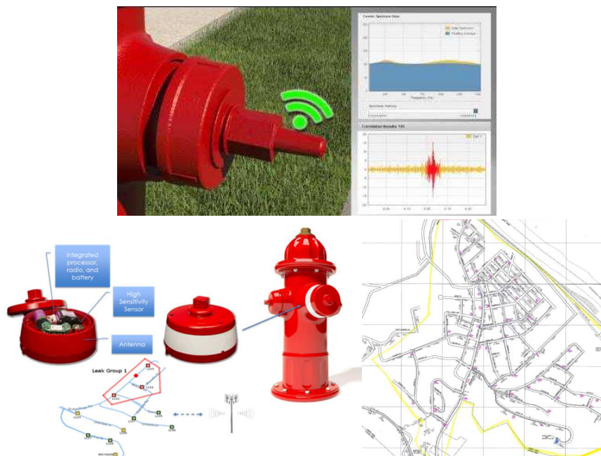
圖 47 Fixed Leak Detection 的操作方式
