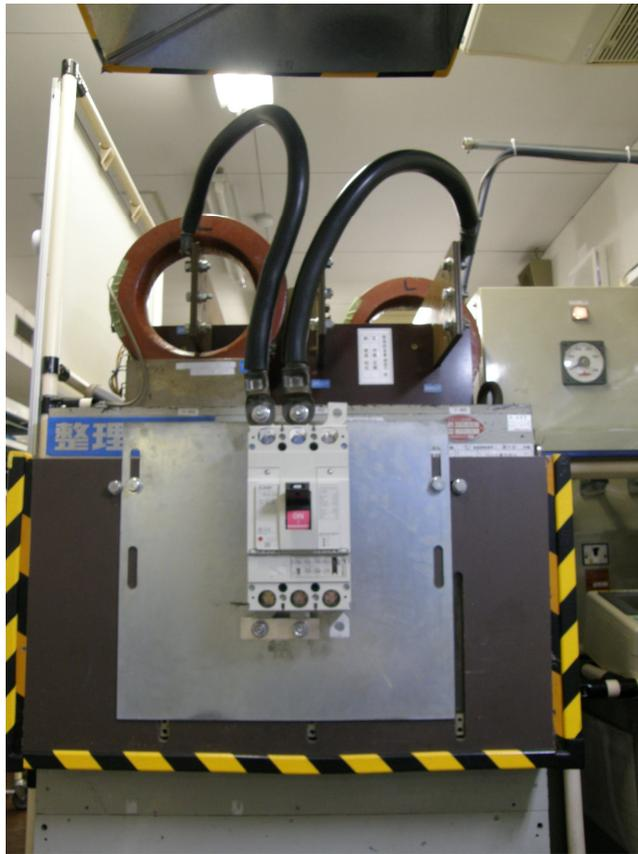
圖 14 品管試驗室的瞬時跳脫測試設備與抽測樣品 (3P 400A)
