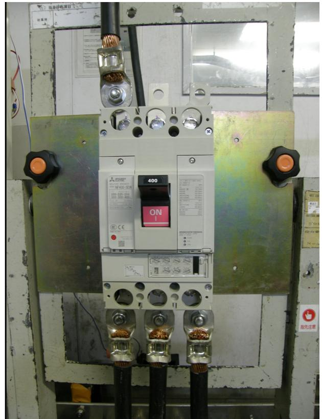
圖 13 品管試驗室的跳脫測試設備與抽測樣品 (3P 400A)
