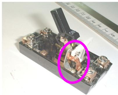
圖 4 熱動式斷路器實體內部構造
