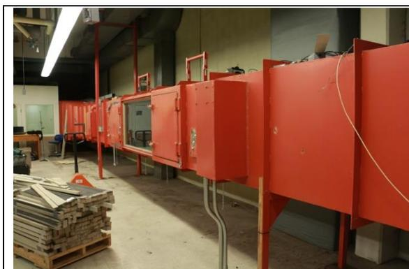
圖三十八、高速風洞，正方形斷面邊長為0.91公尺，最大風速可達每秒17.88公尺
