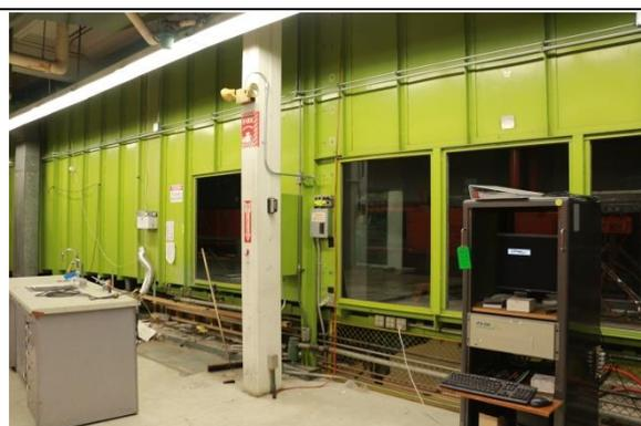
圖三十九、低速風洞，正方形斷面邊長為3.12公尺，最大風速可達每秒3.12公尺
